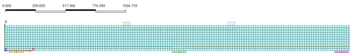
Figura 6.8 – Divisão das malhas em pequenas dimensões dominadas Elementos Finitos
