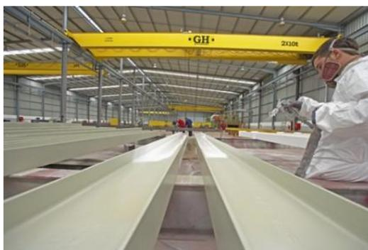
Figura 3.7 – Protecção por esquemas de pintura (FastSteel, 2013)
