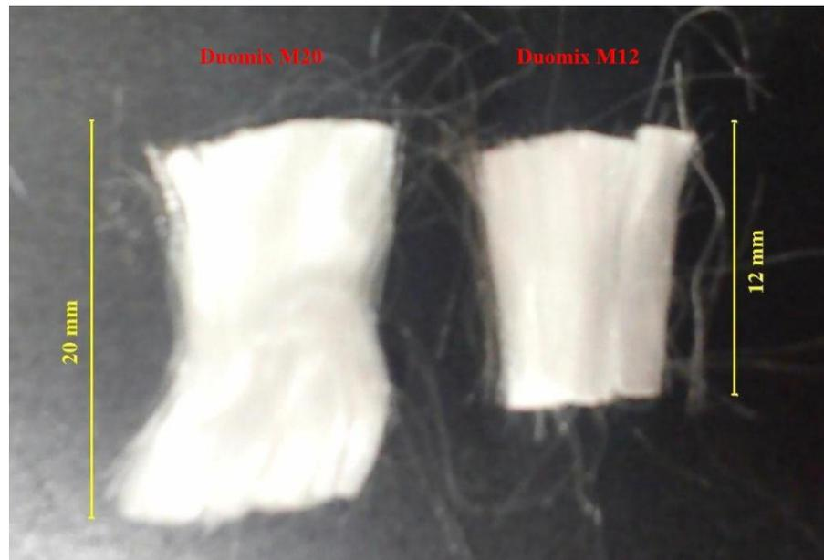
Figura 3.4 – Ilustração comparativa das dimensões das fibras *DuomixM12* e *DuomixM20*.
