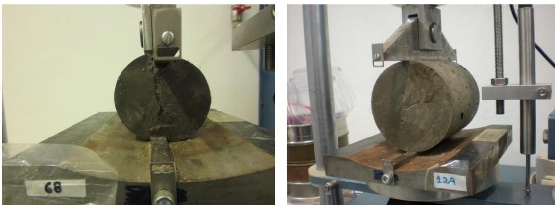
Figura 4.7 – Aspecto da amostra durante o ensaio de CD.
