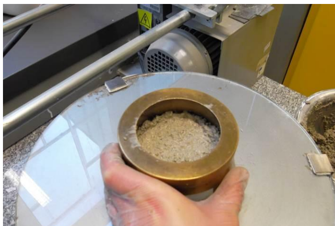
Figura 3.7- Primeira camada compactada.
