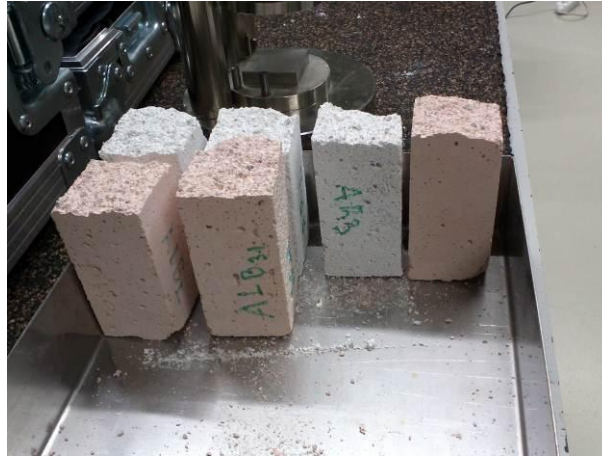
Figura 3.13 – Provete resultantes do ensaio à flexão.
