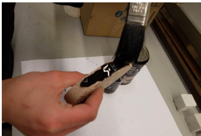
Figura 3.9 – Impermeabilização da parte lateral do provete com uma camada de borracha líquida.
