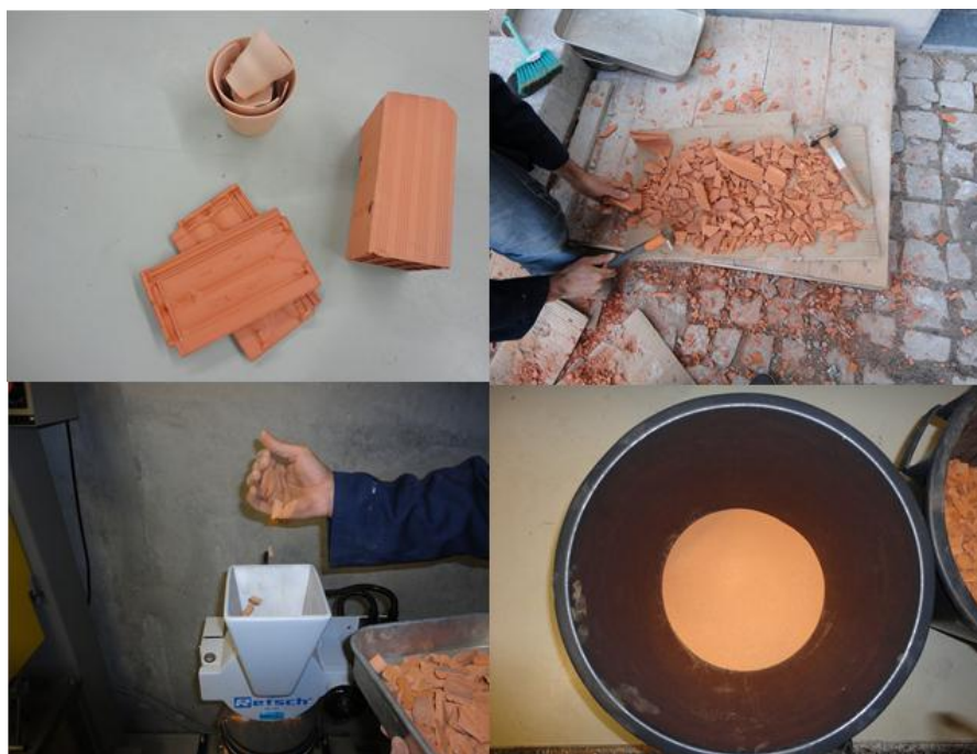
Figura 3.1- Processo de moagem dos resíduos da indústria cerâmica.
