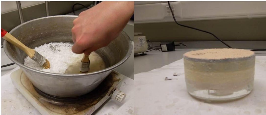
Figura 3.10 – Preparação da parafina (à esquerda) para selagem da tina de ensaio (à direita).
