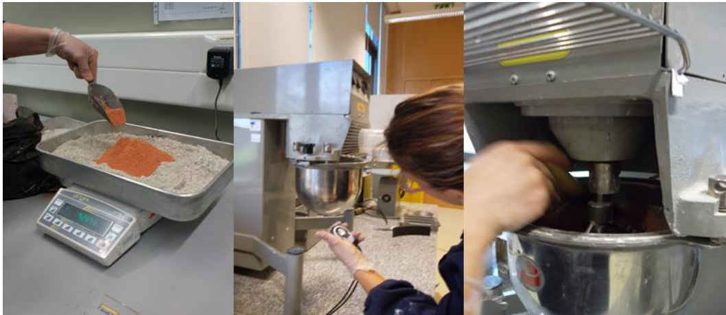
Figura 3.4 – Processo de elaboração das argamassas desde as pesagens até à amassadura das misturas
