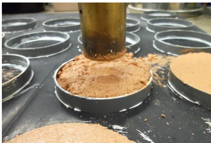
Figura 3.6 - Compactação da argamassa com auxílio de um pilão.
