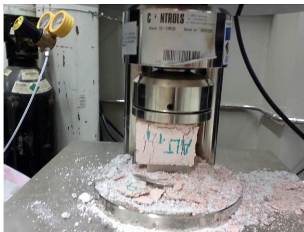
Figura 3.14 – Ensaio de resistência à compressão.
