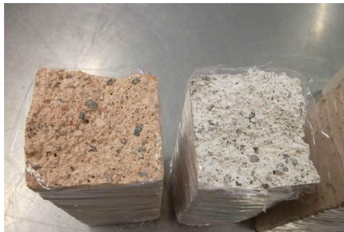
Figura 3.15 – Provetes selados lateralmente com papel celofane.
