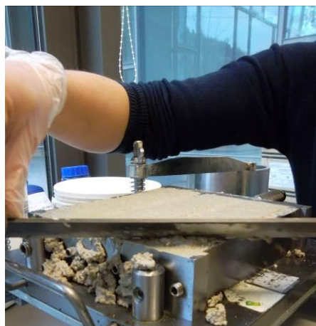
Figura 3.5 - Nivelamento da superfície de um provete prismático com auxílio de uma rasoira.
