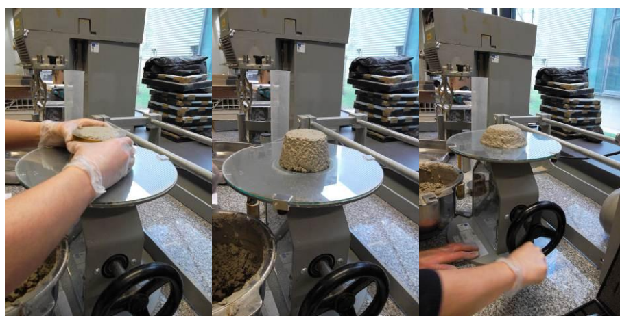
Figura 3.8 – Processo de retirada do molde e aplicação de 15 pancadas.
