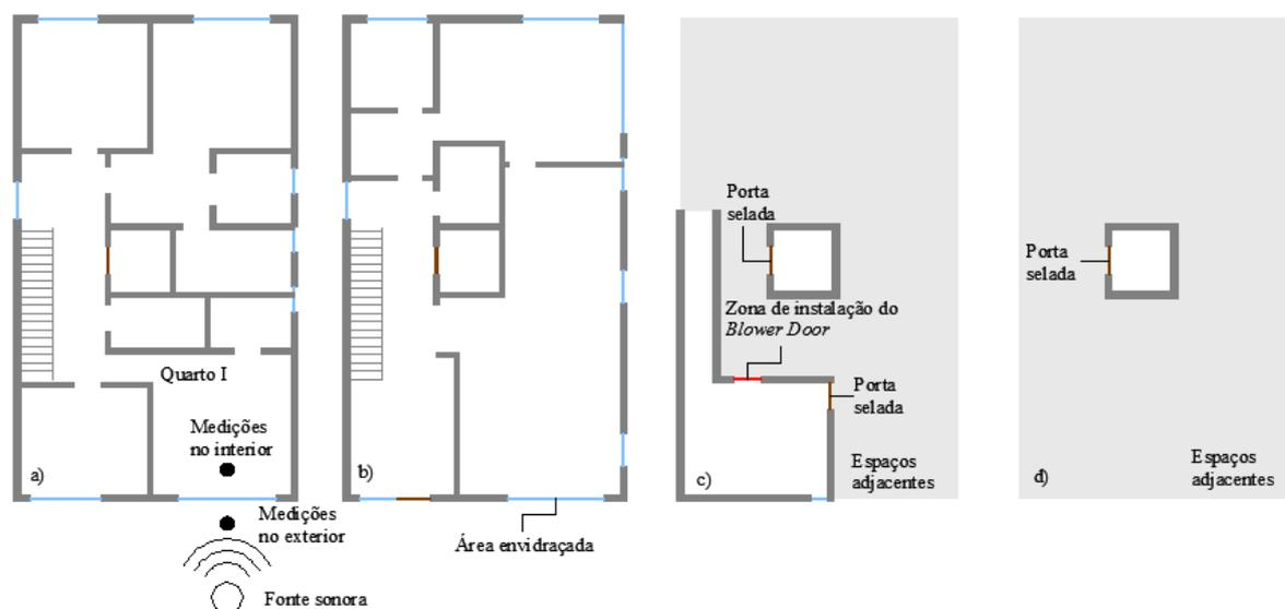
Figura 4.15 – Moradia I, situação I-1: a) piso 2: planta relativa ao ensaio de isolamento sonoro com representação esquemática da posição do microfone e da fonte sonora; b) planta piso 1; c) piso 0: planta com representação da zona de instalação do equipamento do ensaio de permeabilidade; d) planta piso -1.
