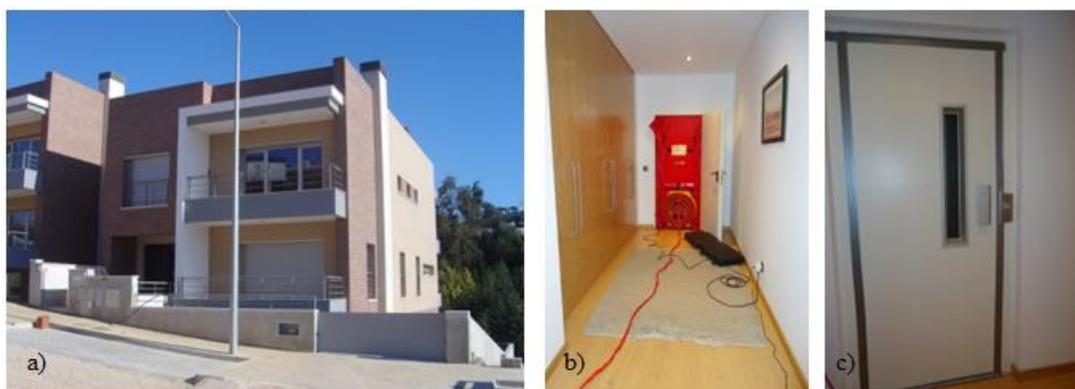
Figura 4.14 – Fotografias da moradia I: a) fachada principal e lateral; b) instalação do *Blower Door*; c) porta de elevador selada.
