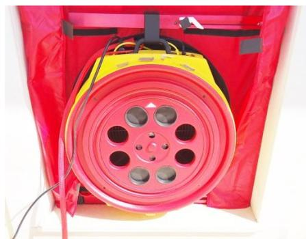
Figura 3.2 – Ventilador em funcionamento, com 8 aberturas destapadas.
