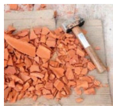
Figura 4.1 Resistência à fragmentação - processo de moagem das amostras
