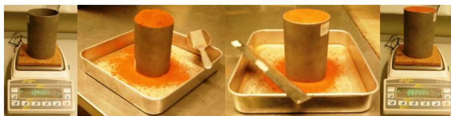
Figura 4.7 Baridade e volume de vazios - procedimento de ensaio
