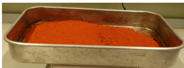
Figura 4.4 Massa volúmica e absorção de água - amostra inicial recolhida
