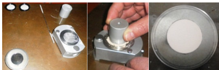
Figura 4.10 Análise mineralógica - preparação do provete de ensaio
