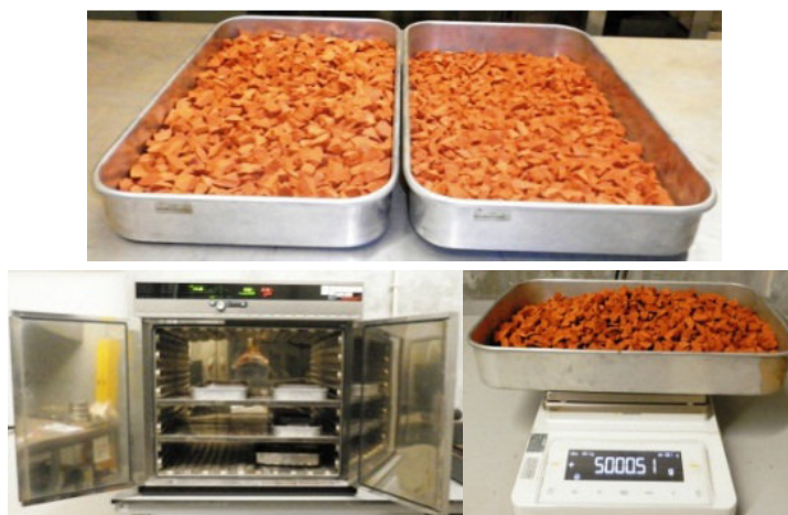
Figura 4.2 Resistência à fragmentação - preparação do provete de ensaio
