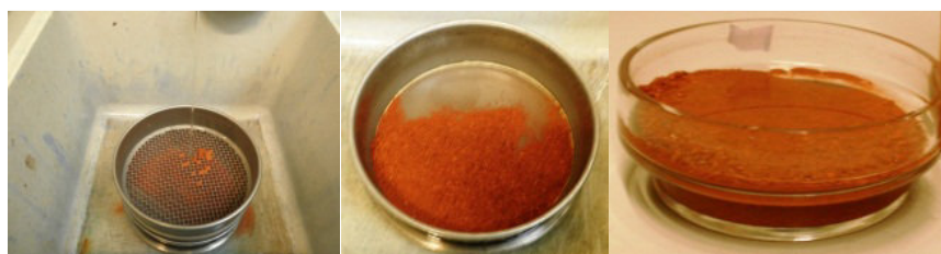
Figura 4.5 Massa volúmica e absorção de água - preparação do provete de ensaio
