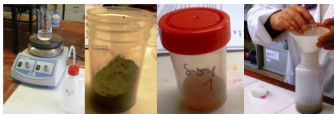
Figura 4.16 Avaliação da pozolanicidade - Procedimento de ensaio (preparação dos provetes)
