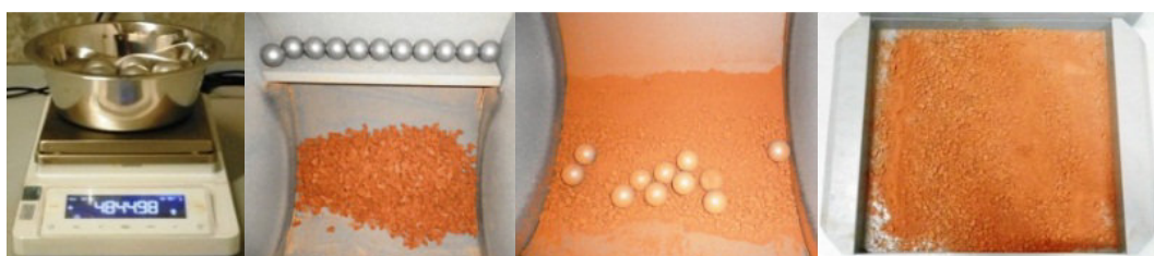
Figura 4.3 Resistência à fragmentação - procedimento de ensaio
