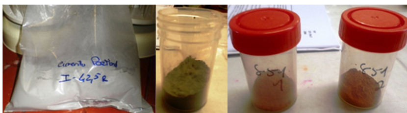
Figura 4.15 Avaliação da pozolanicidade - preparação das amostras ensaiadas
