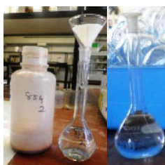
Figura 4.18 Avaliação da pozolanicidade - procedimento de ensaio (filtração)
