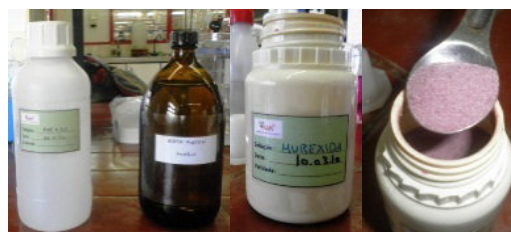
Figura 4.17 Avaliação da pozolanicidade - procedimento de ensaio (reagentes e soluções)
