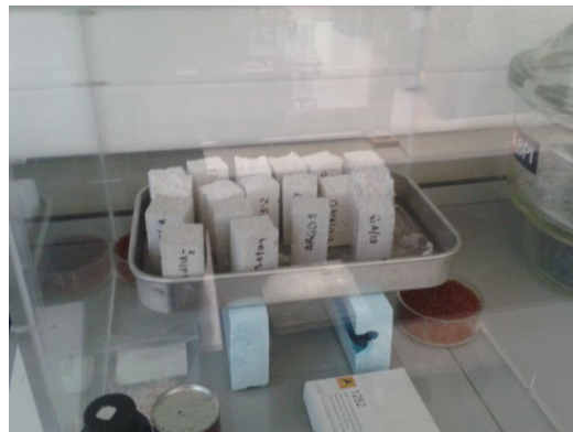
Figura 3.10: Provete colocados dentro do exsiccador com sílica
