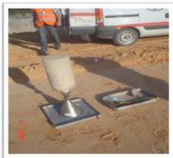
Figura 3.2 – Ensaio de baridade com garrafa de areia
