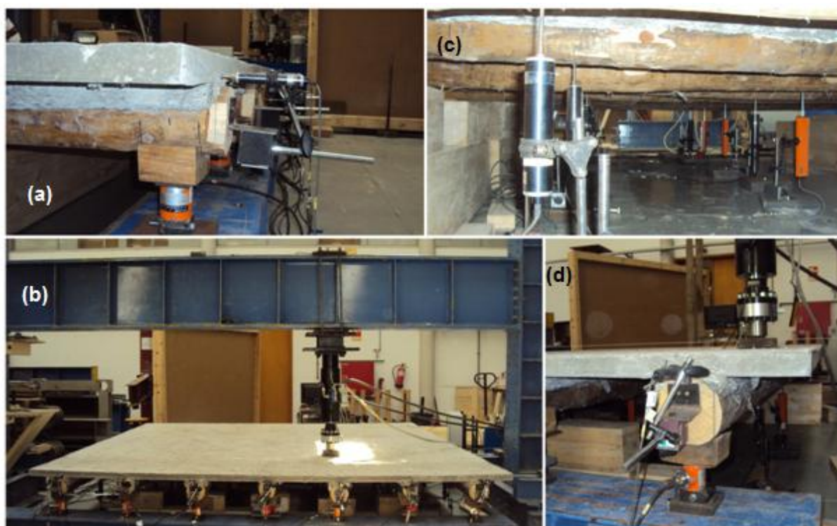
Figura 4.2 - Pormenores do ensaio da laje com elementos de madeira de seção circular: (a) Defletómetro de escorregamento e célula de carga (laranja); (b) Esquema de ensaio; (c) Defletómetros de meio-vão e quarto-de-vão; (d) Pormenor do carregamento.
