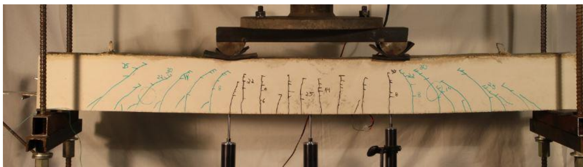
Figura 4.13- Desenvolvimento de fissuras da Viga VM2.
