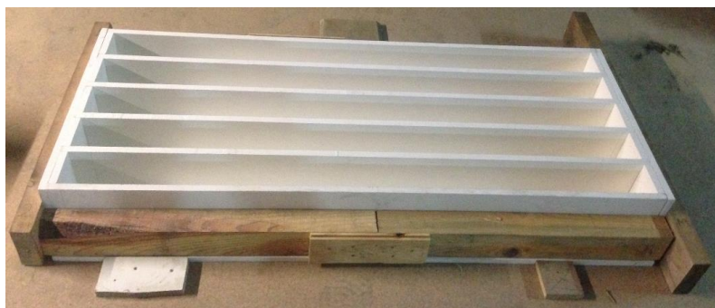
Figura 3.2- Cofragem utilizada na construção das vigas.
