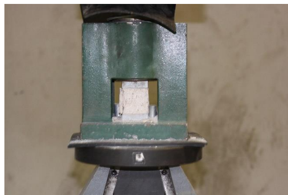
Figura 3.11- Esquema de ensaio de compressão.
