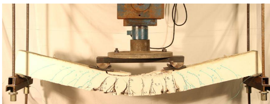
Figura 4.4- Ensaio da VM1 - instantes antes da rotura.
