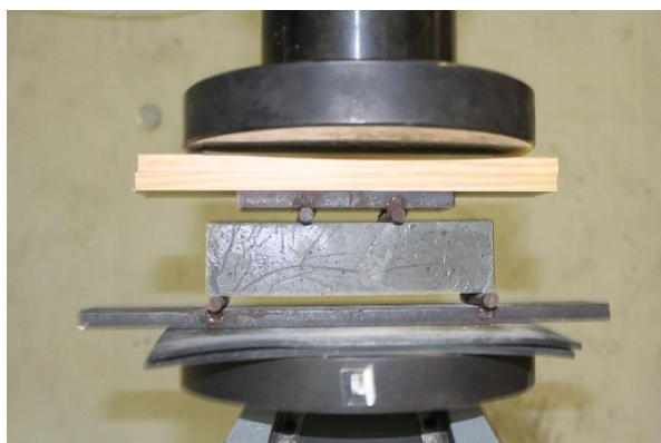
Figura 3.10- Esquema do ensaio de tração por flexão.
