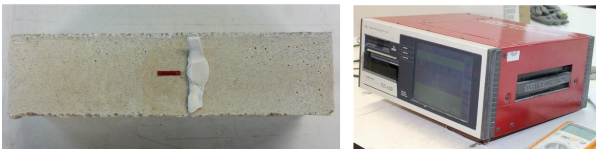
Figura 3.7 – Provete instrumentado com extensómetro (esquerda) e DataLogger (direita).
