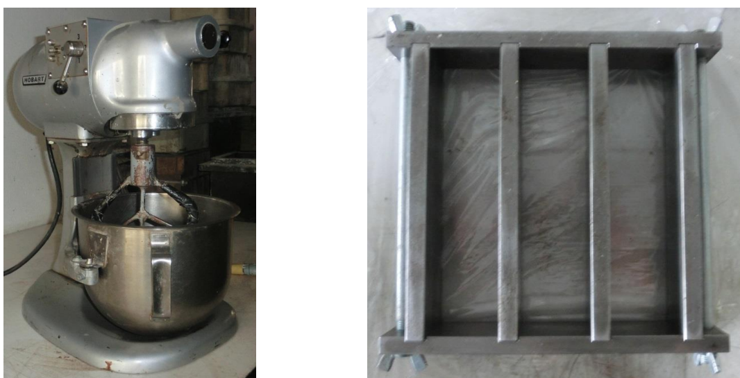
Figura 3.4 – Misturadora da amassadura (esquerda) e moldes (direita).
