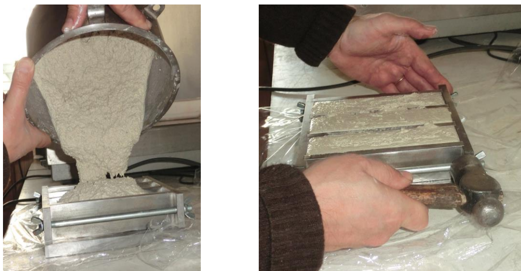
Figura 3.5 – Betonagem e compactação dos provetes.
