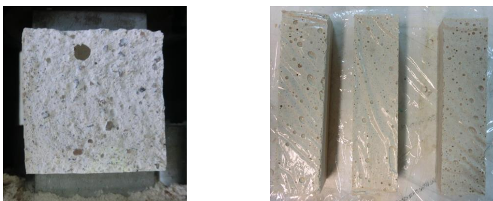
Figura 4.3 – Vazios encontrados no interior de alguns provetes (esquerda) e bolhas superficiais (direita).
