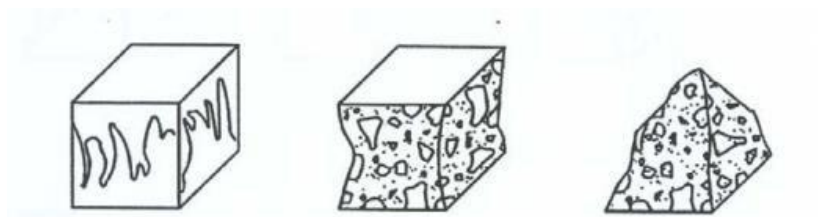
Figura 3.13 – Tipos de roturas satisfatórias segundo a norma NP EN 12390-3.
