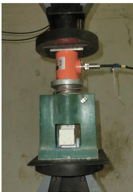
Figura 3.12 – Esquema do ensaio de rotura à compressão.
