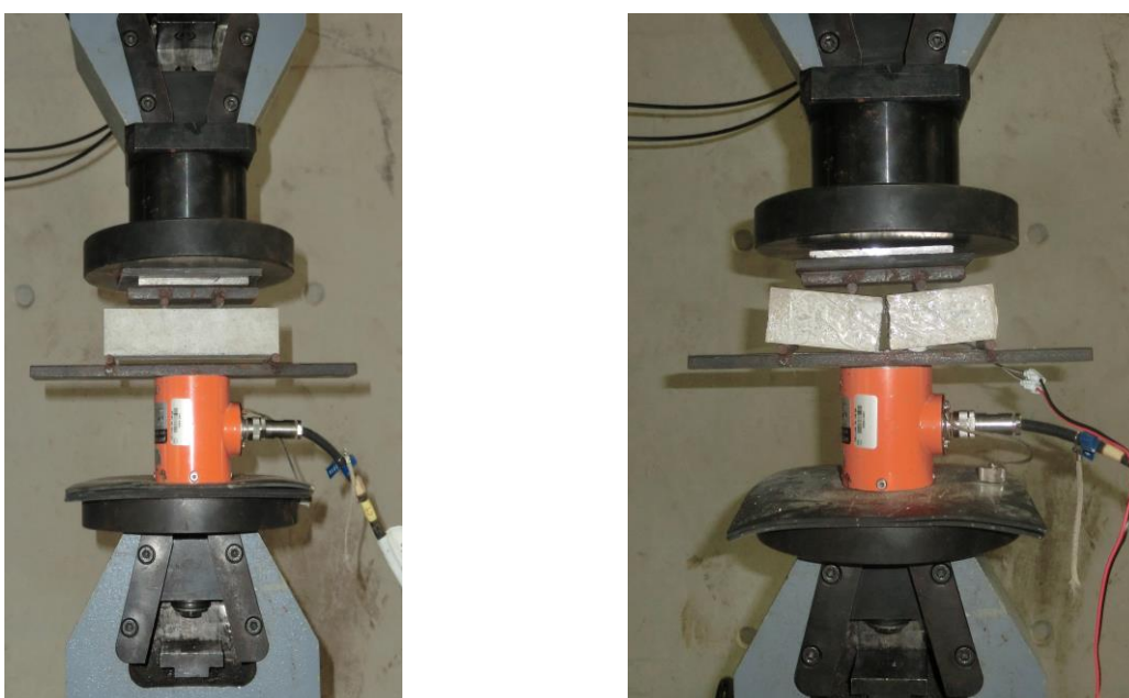
Figura 3.11 – Esquema do ensaio de rotura à tracção.
