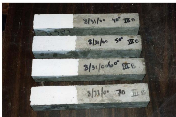
Figura 2.6 – Betão revestido com GP após exposição à água salgada (Torgal et al, 2012).
