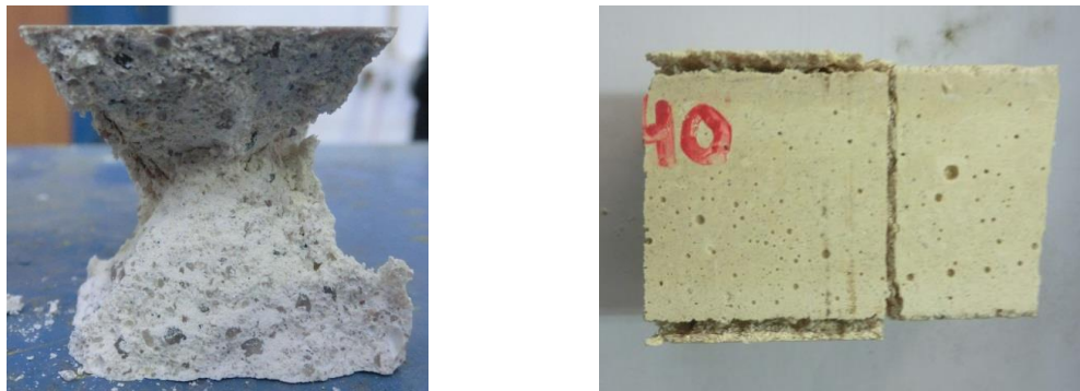
Figura 4.14 – Roturas tipo atingidas pelos provetes submetidos ao ensaio de rotura à compressão.
