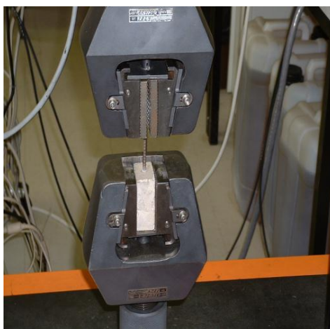
Figura 2.1 – Ensaio de arranque por tracção (Pinto, 2002).
