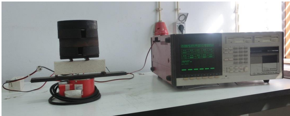
Figura 3.9 – Esquema do ensaio de tracção por flexão em fase elástica.
