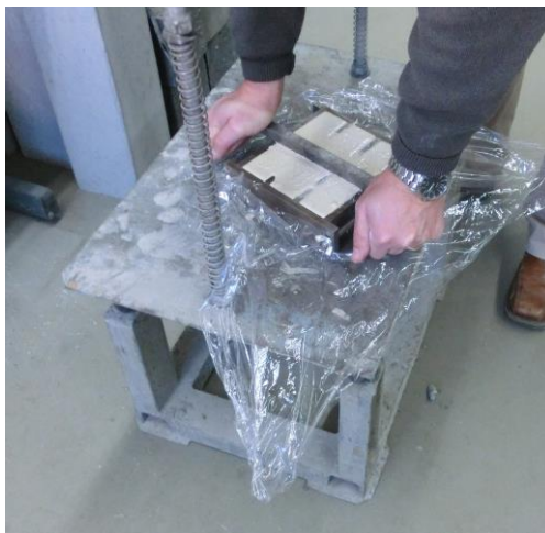
Figura 3.15 – Mesa vibratória utilizada na compactação do material.
