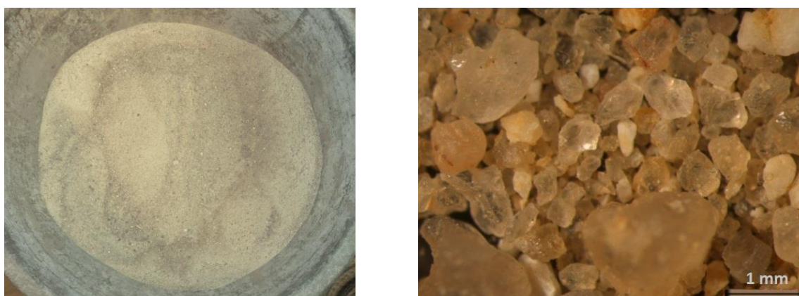
Figura 3.2 – Imagens macro (esquerda) e micro (direita) da areia usada nas misturas.
