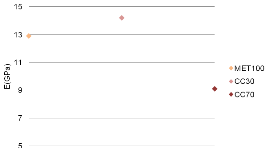
Figura 4.2 – Influência da presença de Cerâmica Cozida no valor E_0 .
