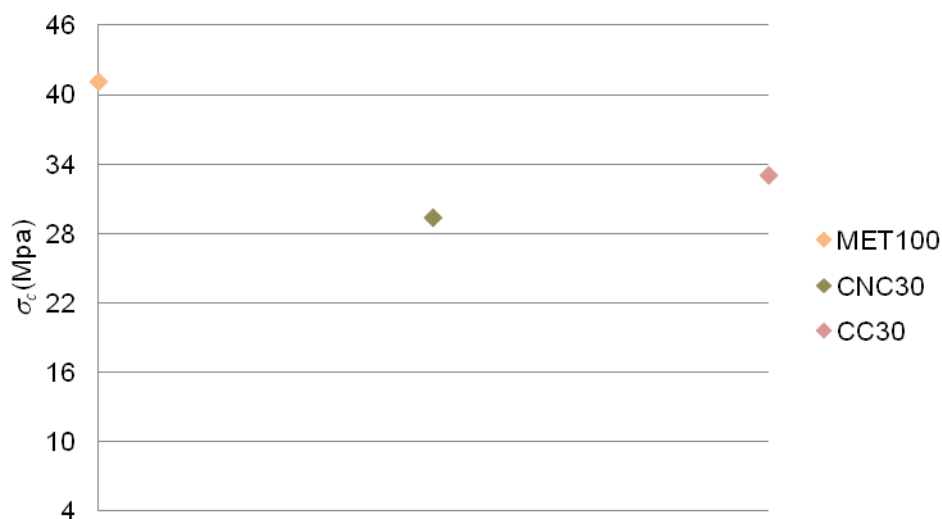
Figura 4.30 – Influência da presença de 30% Cerâmica no valor \sigma_c .
