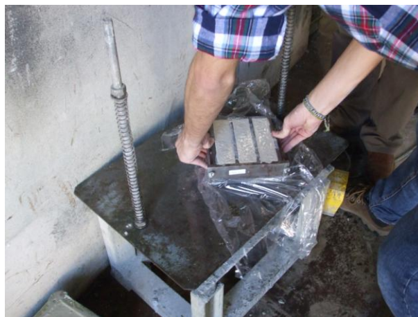
Figura 3.12 – Compactação dos provetes na mesa vibratória.
