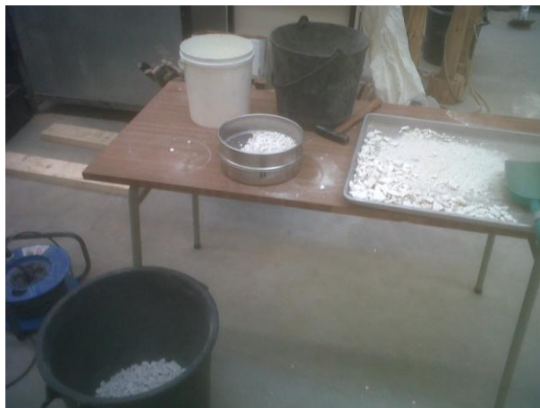
Figura 3.6 - Fragmentação e peneiração da Cerâmica cozida.
