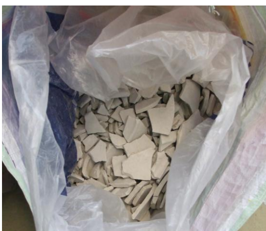
Figura 3.4 - Fragmentos de Cerâmica Não Cozida.
