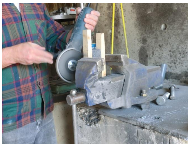
Figura 4.23 - Processo de ajuste dos provetes CF70.
