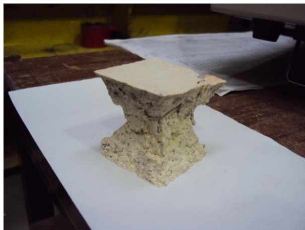
Figura 4.22 – Resíduo de um ensaio à compressão (CC70).
