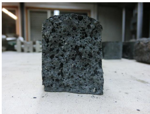
Figura 3.15 - Porosidade dos provetes CF70 .
