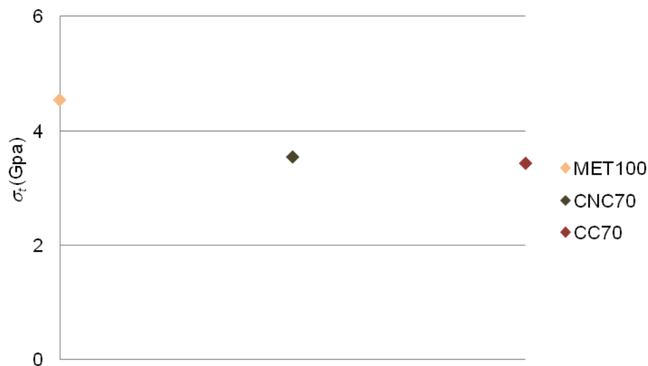
Figura 4.18 – Influência da presença de 70% Cerâmica no valor \sigma_t .
