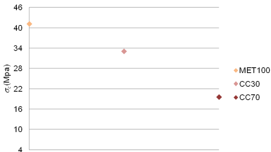
Figura 4.26 – Influência da presença de Cerâmica Cozida no valor \sigma_c .
