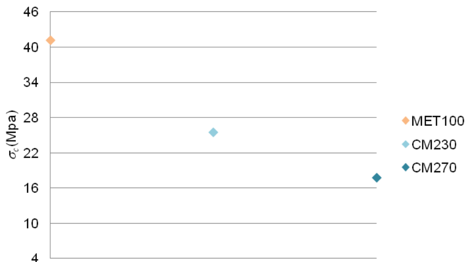
Figura 4.29 – Influência da presença de Cinza Média 2 no valor \sigma_c .
