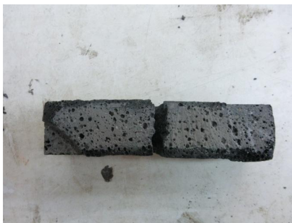
Figura 4.24 - Resultado do ajuste antes do ensaio de compressão.
