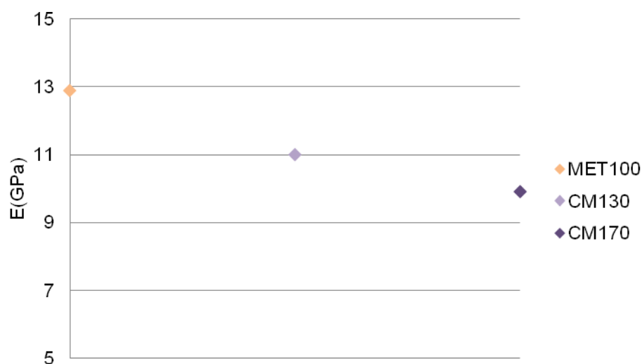
Figura 4.4 – Influência da presença de Cinza Média 1 no valor E_0 .
