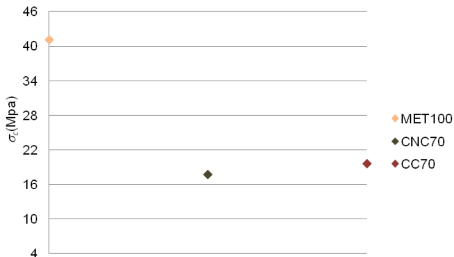
Figura 4.31 – Influência da presença de 70% Cerâmica no valor \sigma_c .
