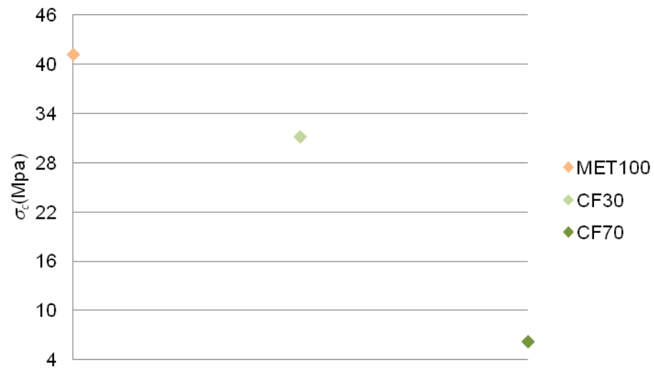
Figura 4.27 – Influência da presença de Cinza Fina no valor \sigma_c .
