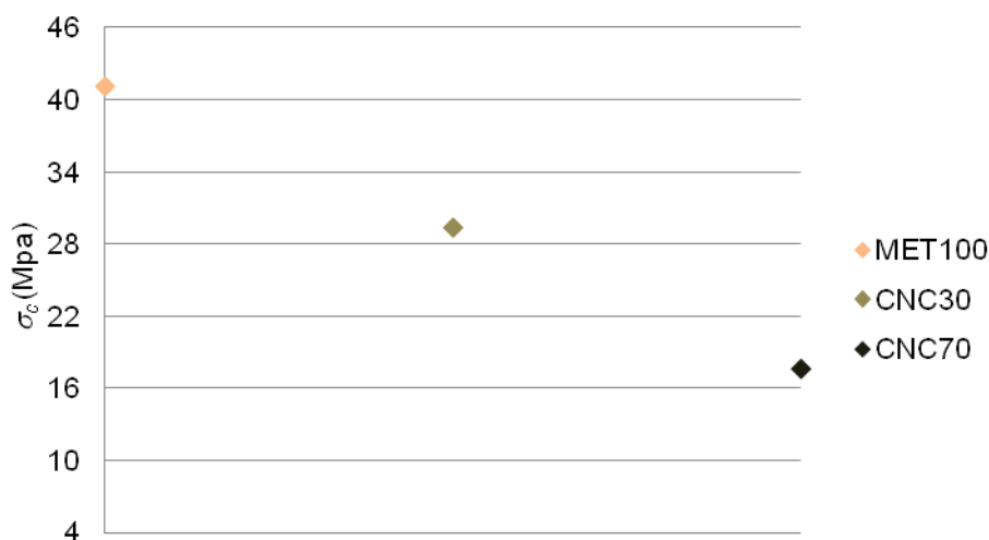
Figura 4.25 – Influência da presença de Cerâmica Não Cozida no valor \sigma_c .
