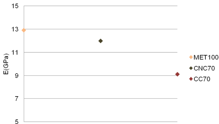
Figura 4.7 – Influência da presença de 70% Cerâmica no valor E_0 .
