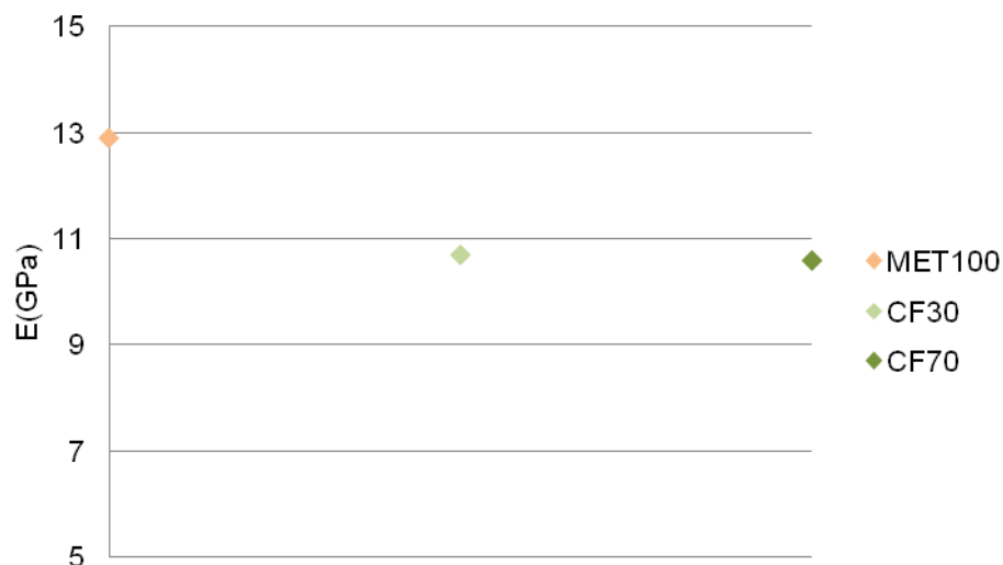
Figura 4.3 – Influência da presença de Cinza Fina no valor E_0 .
