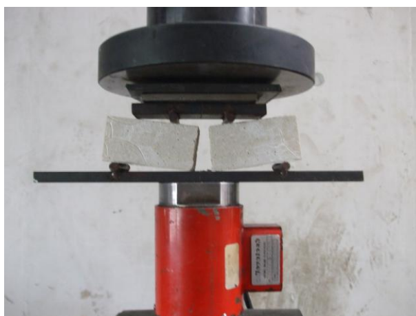
Figura 4.10 - Ensaio de rotura à tração (mistura CC70) após rotura.
