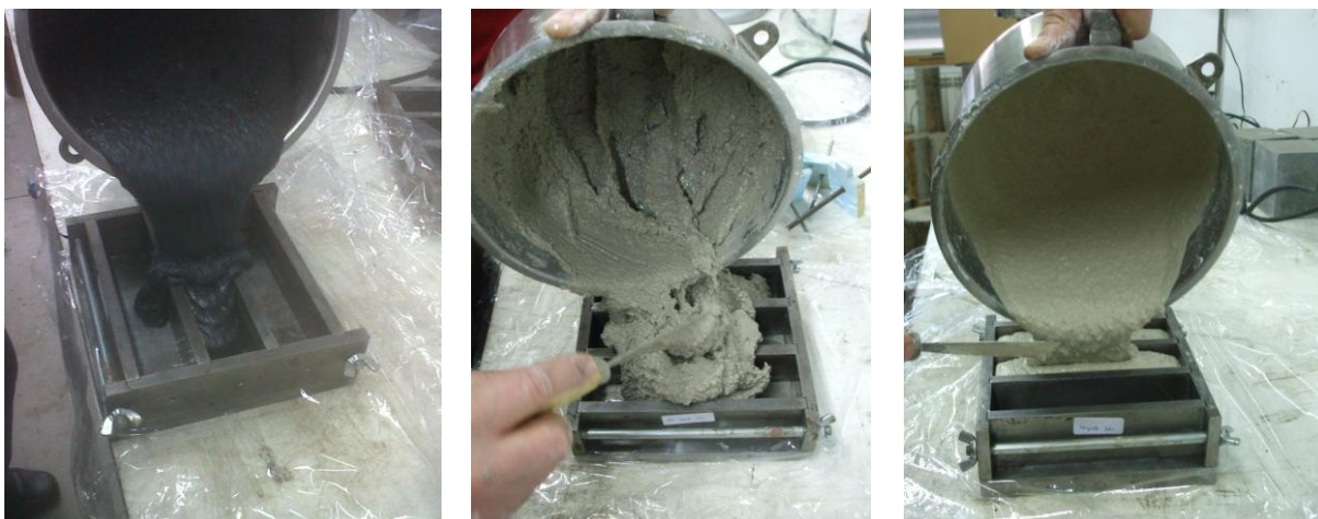
Figura 3.9 – Colocação da mistura nos provetes.
