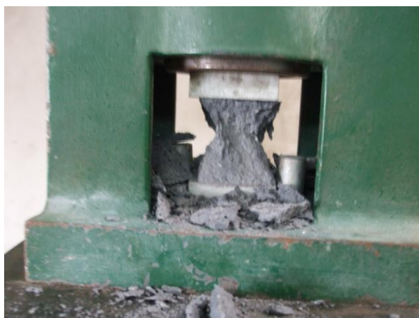
Figura 4.21 - Provetes sujeito a ensaio à compressão ( CM1 ).
