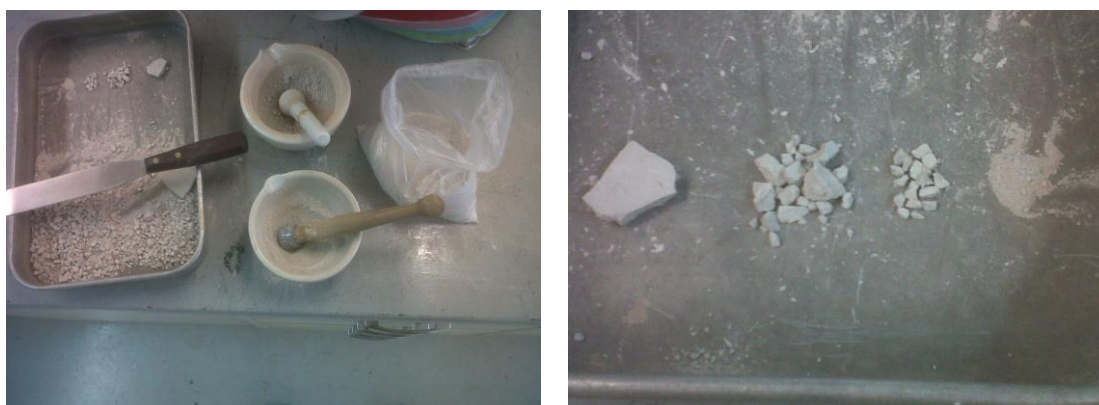
Figura 3.5 - Fragmentação da Cerâmica não cozida.
