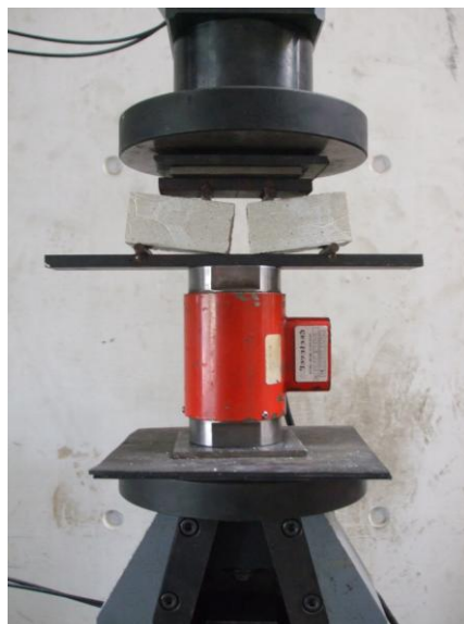
Figura 3.18 - Esquema do ensaio de rotura à tração por flexão.
