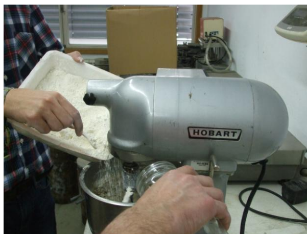
Figura 3.8 – Mistura dos ingredientes na misturadora.
