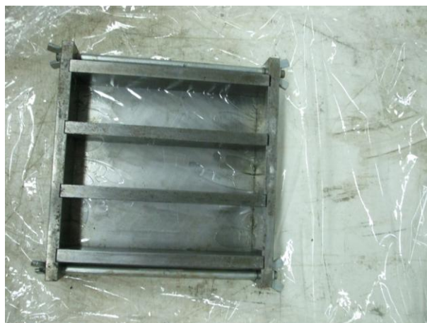
Figura 3.10 – Película plástica colocada já no provete.
