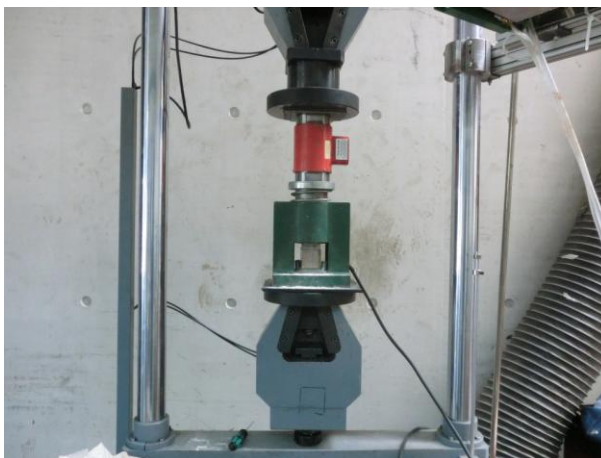
Figura 3.19 - Esquema do ensaio de rotura à compressão.
