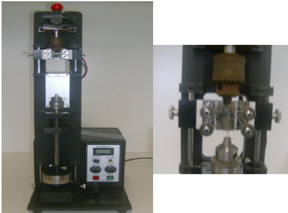
Figura 2.10 – Fotografia do puller usado no estiramento dos capilares de vidro contendo no seu interior uma fibra de carbono.
