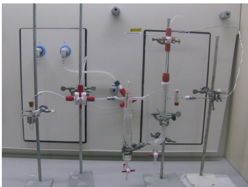
Figura 2.1 – Sistema de purificação e preparação de soluções stock de NO. Este processo ocorre no interior de uma hotte com sistema de ventilação.
