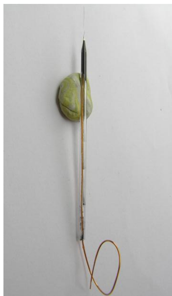
Figura 2.11 – Fotografia representativa de um microel ctrodo de fibra de carbono finalizado.
