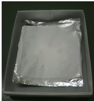
Figura 13 - Filme polimérico biodegradável obtido por *electrospinning* antes do corte.
