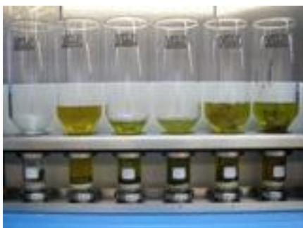
alíquotas foi determinado o teor de proteína não digerida (método de Kjeldahl) e, nas outras duas alíquotas, o teor de cinzas (incineração a 525 °C). A FDT corresponde à massa em percentagem (%) do resíduo após a digestão e filtração, retirando o teor proteico e o teor de cinzas e corrigido também com o valor do branco (controlo).
