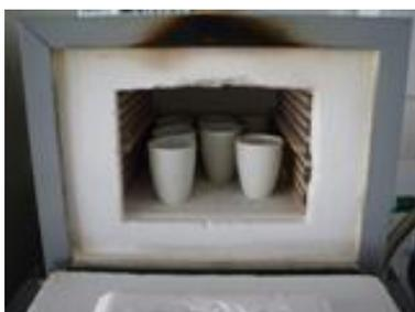
As cinzas foram obtidas por incineração de 1 g de amostra a 500 °C, em mufla (Figura 11) de acordo com o método AOAC 950.153. A análise foi efetuada em triplicado e os resultados apresentados em percentagem (%).
