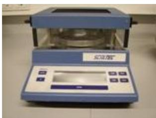
Para a determinação da humidade recorreu-se a uma balança adequada (Figura 10). Aproximadamente 1,5 g de amostra moída foi sujeita a um processo de secagem ( $\pm 100$  °C) até atingir um peso constante. A análise foi efetuada em triplicado e os resultados expressos em percentagem (%).
