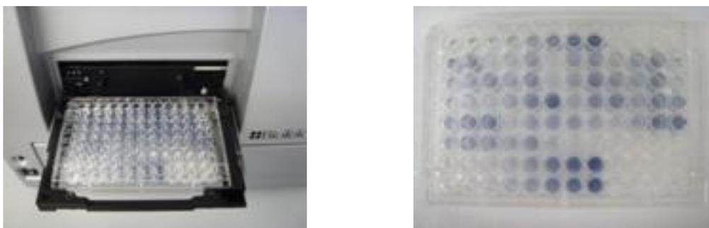
**Figura 16.** Leitura, em leitor de microplacas, do ensaio dos fenóis totais.
