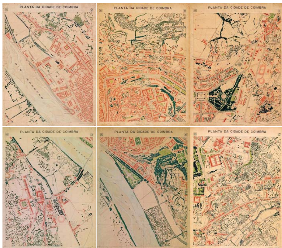
Cartografia: "Planta da cidade de Coimbra" de 1934, à escala 1:1000 Efectuada por fotogrametria a partir da fotografia aérea vertical de 1932
