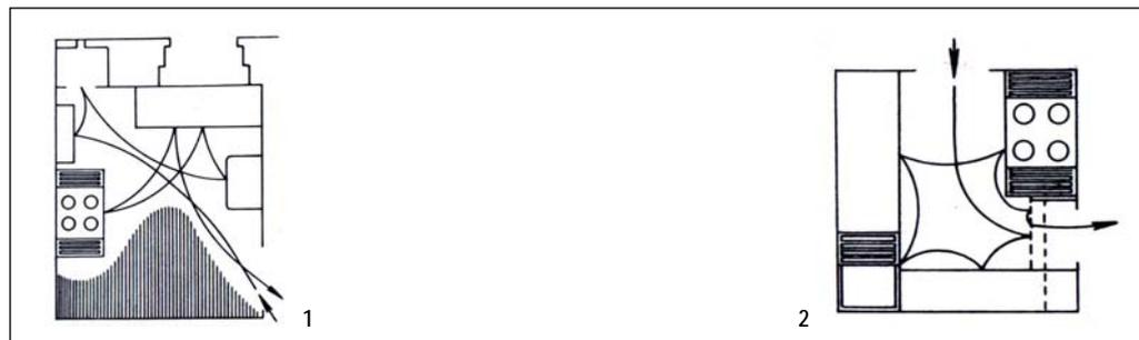
Figg. 1, 2: Cozinha com 7,13 m<sup>2</sup> e cozinha racionalizada com 4,5 m<sup>2</sup>, com gráfico de movimento (área “desperdiçada” a sombreado).
