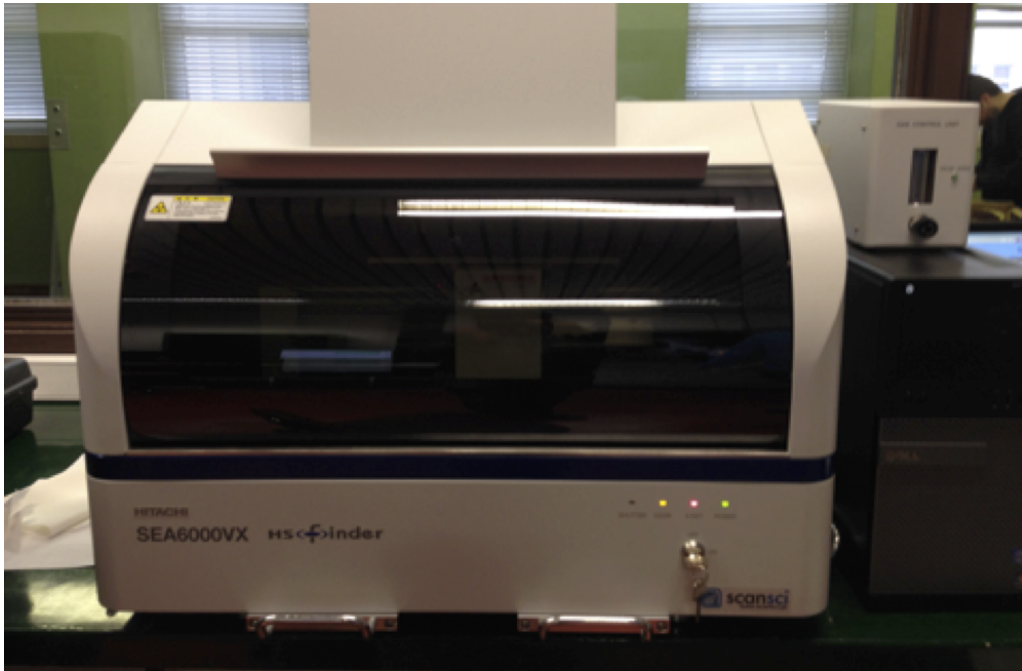
Figura 1: Equipamento de análise por Fluorescência de Raios-X (Hitachi modelo SEA 6000VX) Fonte: imagem fotografada pelo autor.
