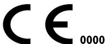
Fig. 10 – Exemplo do símbolo de marcação CE com a identificação do ON.
