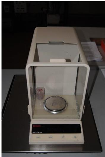
**Figura 3.1** Balança analítica utilizada.
