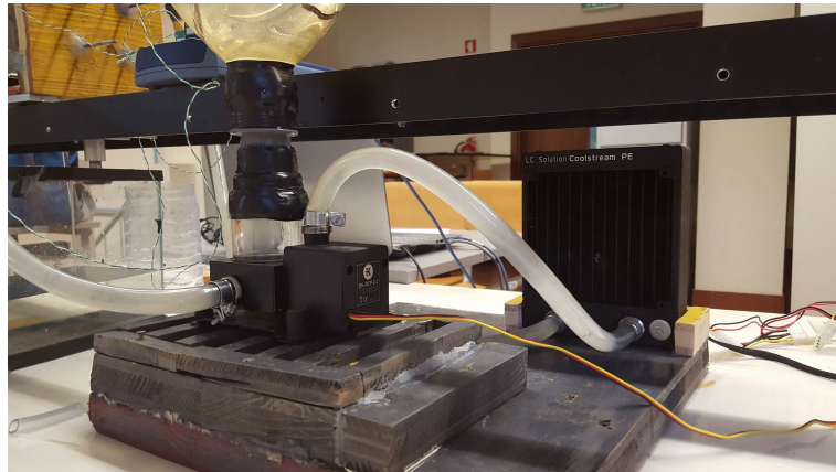
Figura 3.3: Bomba e Ventilador+Radiador
