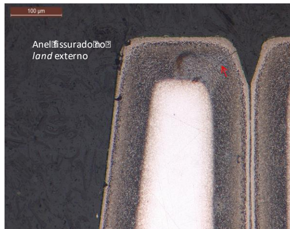
Figura 5.6 Micrografia de um anel I-Shaped fissurado no land externo, após nitruração gasosa. Corpo de prova atacado com o reagente nital 2% (Mahle componentes de Motores S.A.).
