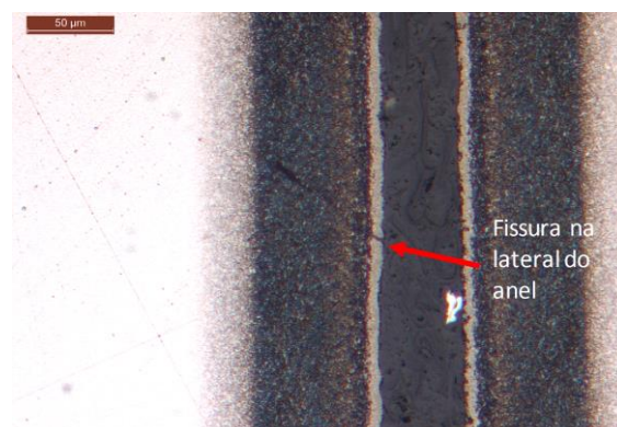
Figura 5.5 Micrografia de um anel I-Shaped fissurado na lateral, após nitruração gasosa. Corpo de prova atacado com o reagente nital 2% (Mahle componentes de Motores S.A.).
