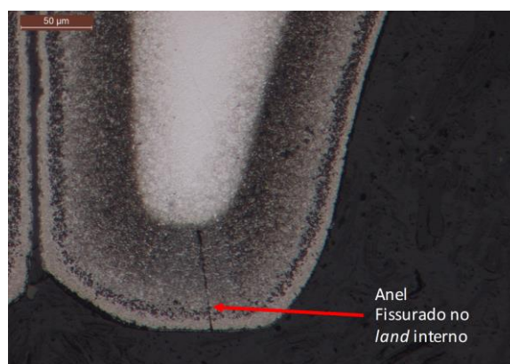
Figura 5.4 Micrografia de um anel I-Shaped fissurado no land interno, após nitruração gasosa. Corpo de prova atacado com o reagente nital 2% (Mahle componentes de Motores S.A.).
