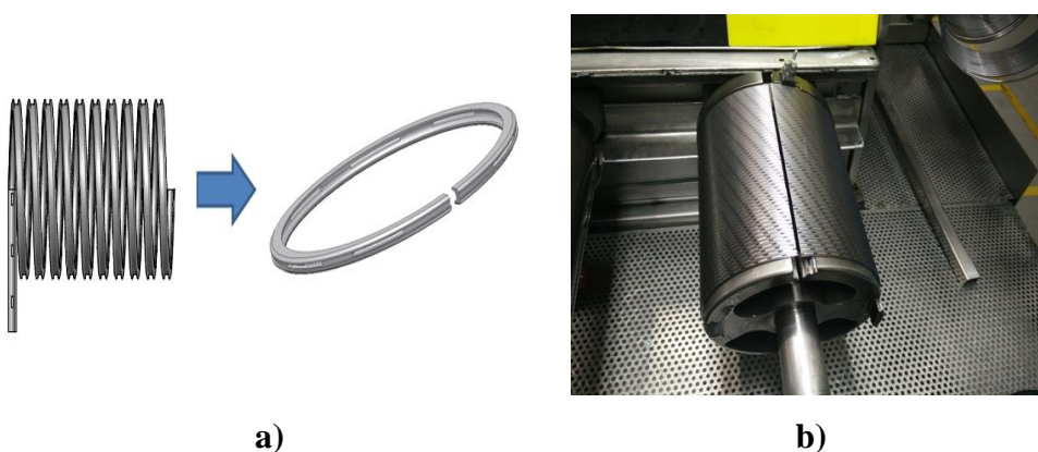
Figura 3.9.a) esquema do corte da bobine para formar os anéis. b) Bobine de anéis já cortados na camisa de corte (MAHLE Componentes de Motores S.A).
