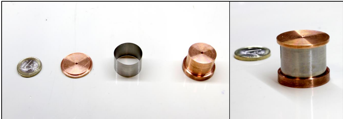
Figura 6-5 - Componentes após maquinação, isoladas e montadas, respetivamente.
