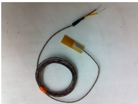
Figura 3.4: Termopares SA1XL do tipo K da Omega.
