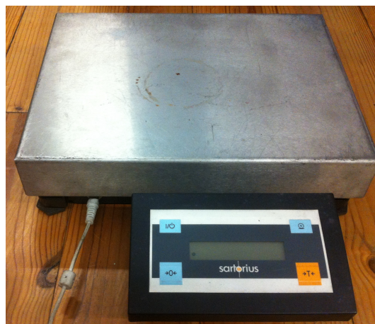
Figura 3.6: Balança de precisão da Sartorius EB15DCE – I .
