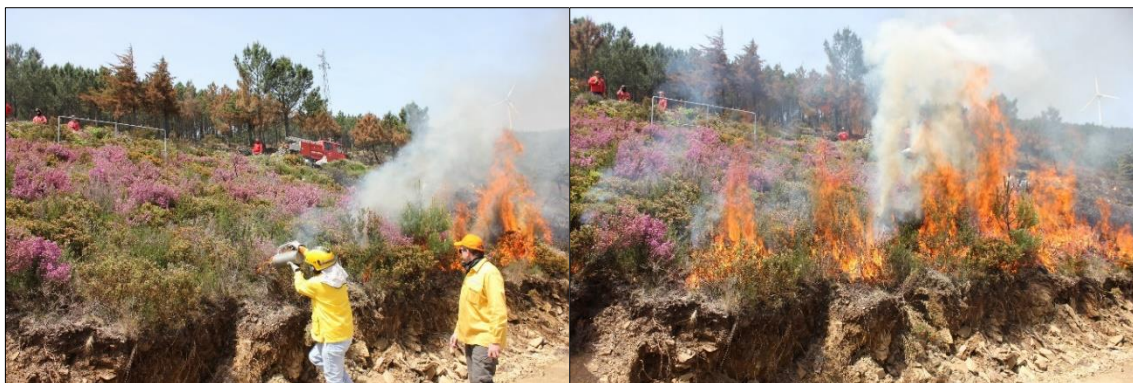
Figura 2.16. Ignição linear e propagação inicial do fogo. Fonte: CEIF/ADAI
