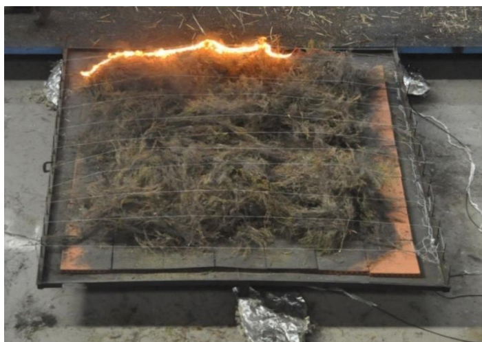
Figura 2.4. Instrumentação da plataforma, régua de pinos com os fios de linho e ignição linear do leito combustível. Fonte: CEIF/ADAI, 2015
