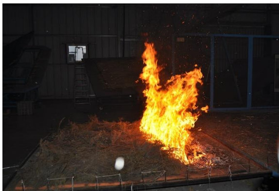
Figura 3.10. Ensaio para U=0 m/s (1-REF-0.1). Fonte: CEIF/ADAI, 2015
