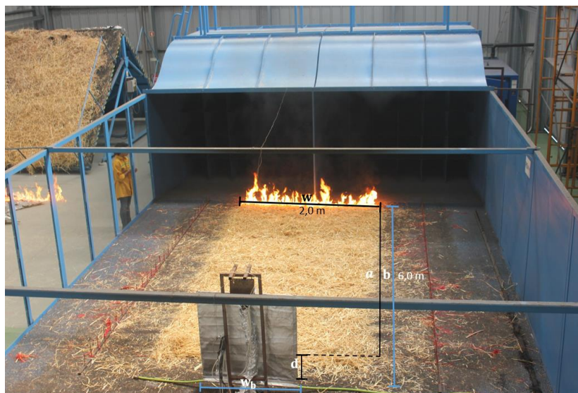
Figura 2.11. Esquema da delimitação das áreas (Barreira 2 – LEIF)
