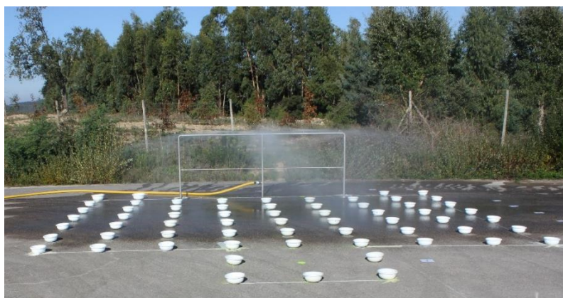
Figura 3.44. Aspersão de água pela cerca com 100% de abertura da válvula (Cerca 1.1.).
