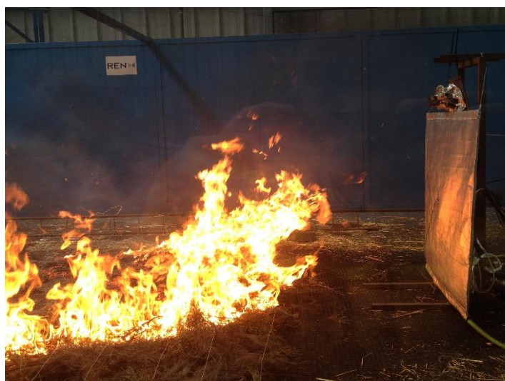
Figura 3.41. Aproximação da frente de chamas à Barreira 2 . Fonte: CEIF/ADAI, 2015
