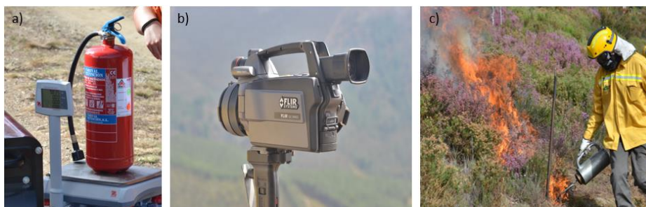
Figura 2.5. Equipamentos utilizados: a) Balança; b) câmara IR; c) pinga-lume. Fonte: CEIF/ADAI, 2015
