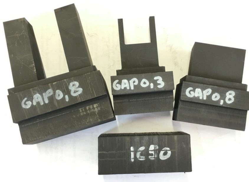
**Figura 2.1 – Elétrodos provenientes da indústria metalomecânica**
