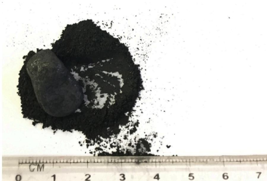
Figura 3.7 – Resultado da exfoliação no moinho de bolas com elétrodo fragmentado
