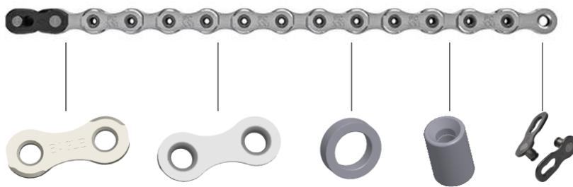
Figura 21 - Estrutura da corrente
