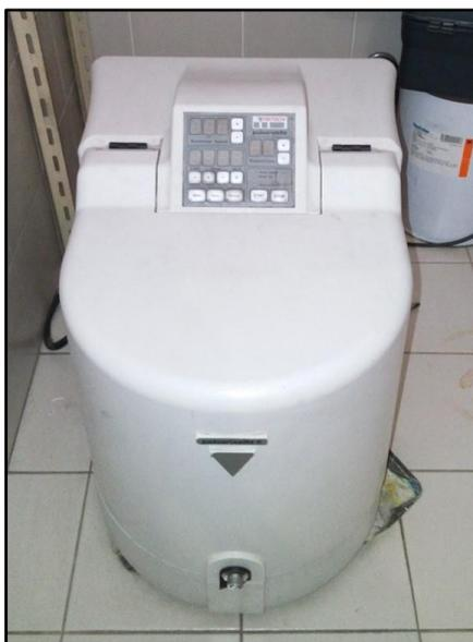
Figura 4.1. Moinho de esferas *Fritsch Pulverisette 6*.
