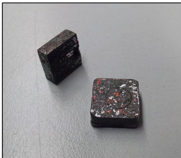
Figura 4.3. Duas pastilhas produzidas por conformação.
