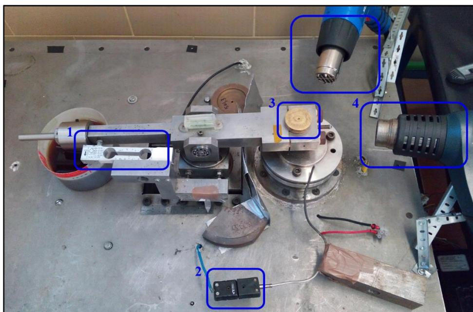
Figura 4.5. Equipamento *Pin-on-disk*.
