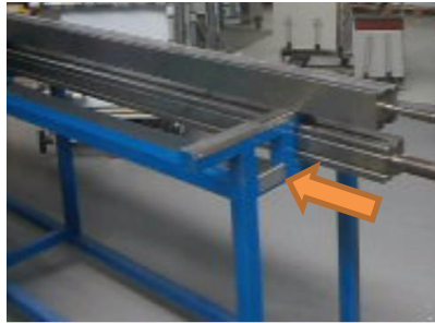
Figura 14: Aplicação da chapa de 1,2 mm no carro de matrizes.
