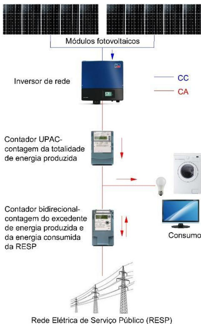
Figura 8 - Esquema do funcionamento das UPAC/UPP (FF Solar, 2016).
