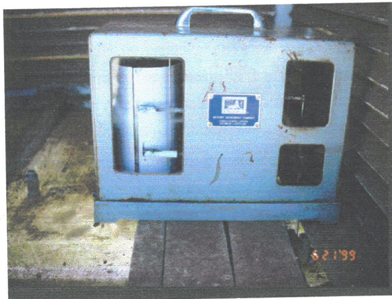
FIGURA 81 - Termohigrógrafo utilizado para medir os índices de umidade relativa do ar do município.
