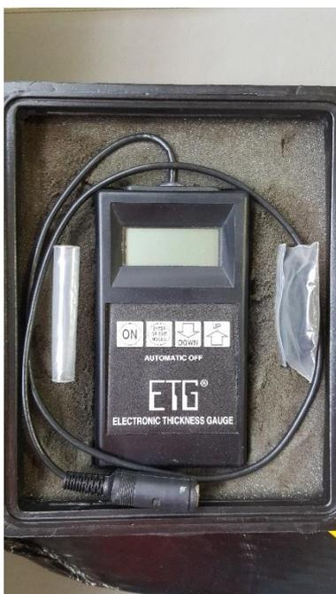
**Figura 29** - Aparelho de medição de espessuras, vista frontal
