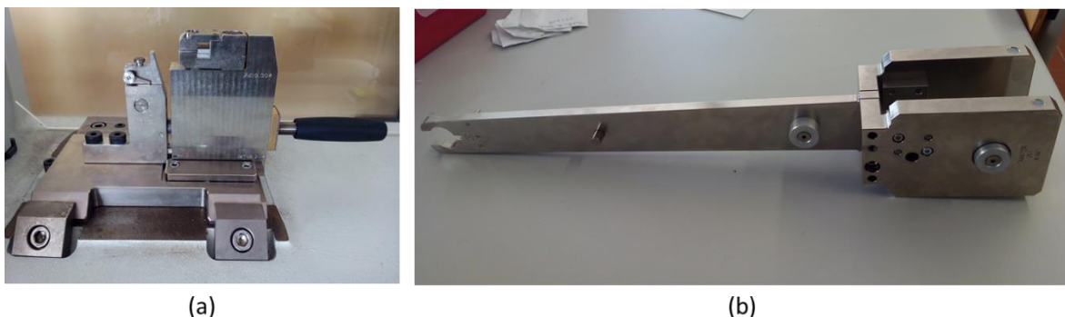
Figura 3.13. Acessórios utilizados no ensaio de impacto longitudinal: (a) Base de apoio; (b) Martelo de impacto.
