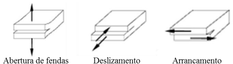
Figura 2.3. Modos de falha por delaminação.
