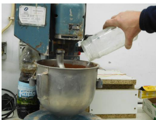
Figura 3.3. Misturadora utilizada na preparação da argamassa.
