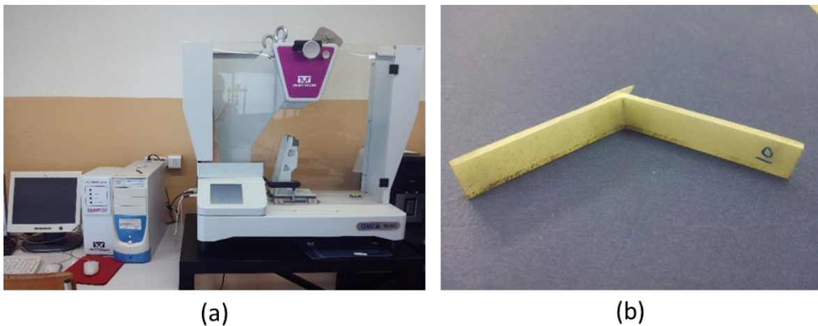
Figura 3.16. (a) Equipamentos utilizados na realização do ensaio de impacto transversal; (b) Provete após ter sido sujeito ao ensaio.
