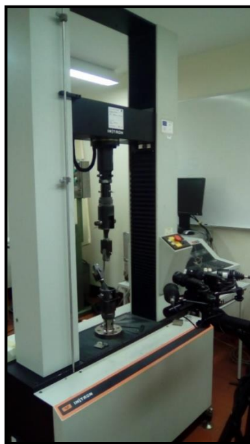
Figura 3.8. Máquina de tração Instron® Model 4206, sistema ótico ARAMIS da GOM – Optical Measuring Technique e consola Instron®
