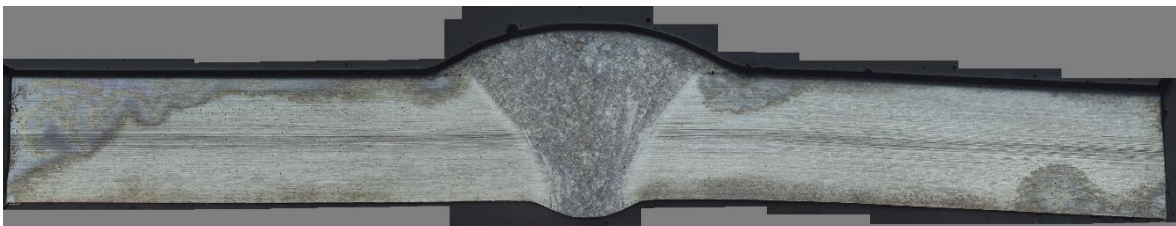
Figura B.5. Macrografia da chapa TT_TE48h.
