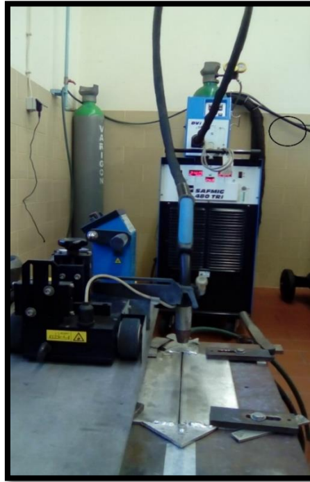
Figura 3.1. Montagem experimental para a realização das soldaduras.
