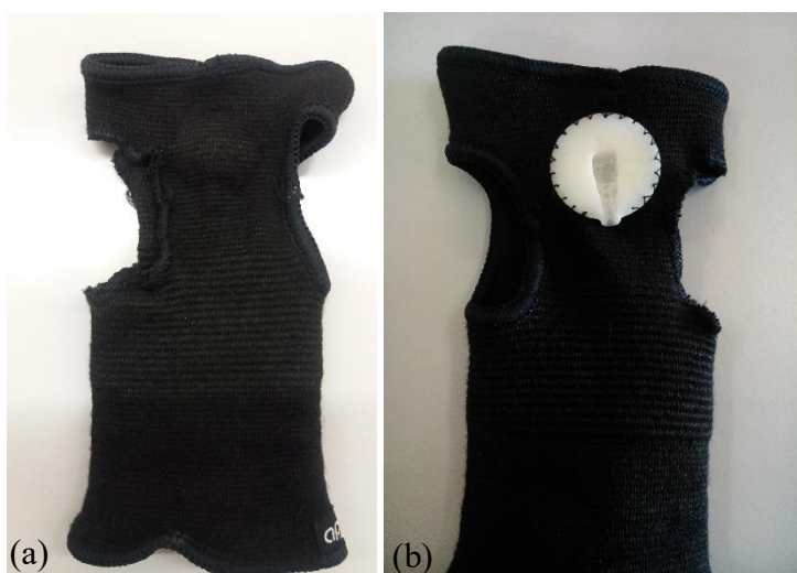
Figura 3.9 – Luva utilizada: (a) parte exterior da luva utilizada na aquisição de dados nos ensaios para o sistema-mão braço, com uma nova abertura de forma a ser utilizada em ambas as mãos dos bateristas; (b) Parte interior da luva onde é visível a peça onde é fixado o acelerómetro.
