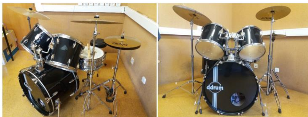
Figura 3.3 – Bateria ddrum modelo Reflex Standard utilizada para aquisição de dados de todos os ensaios realizados. Constituída por um timbalão de chão, dois tom-tom, uma caixa e um bombo. Pratos do conjunto: dois ride com diâmetros diferentes e um prato de choque.
