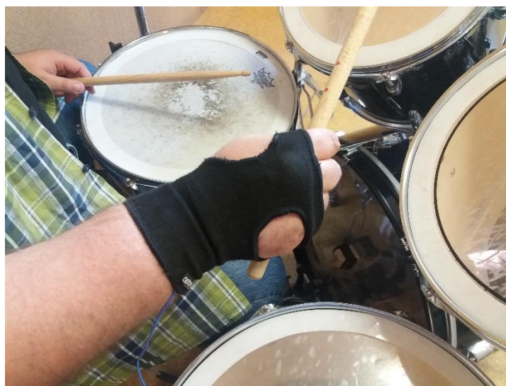
Figura 3.11 – Baterista e a luva instrumentada no ensaio para a recolha de dados das vibrações induzidas pela baqueta na mão direita.
