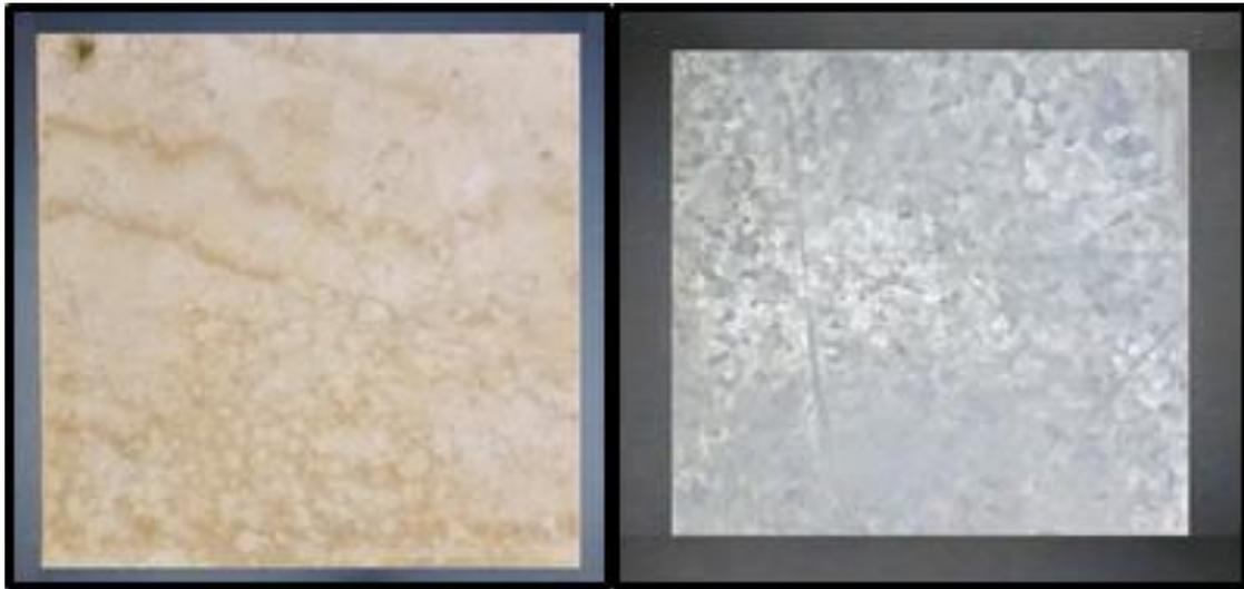
**Figura 2.2.** Amostra 10×10 cm<sup>2</sup> da superfície das placas MDF (esquerda) e da superfície dos chapéus dos balancetes (direita).
