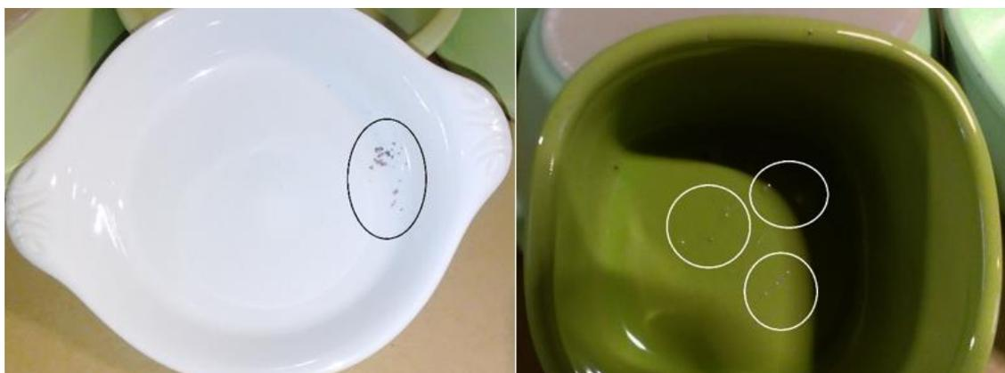
**Figura 1.1.** Ilustração de peças com defeito do tipo pintas pretas (à esquerda) e sujidades e areias (à direita).
