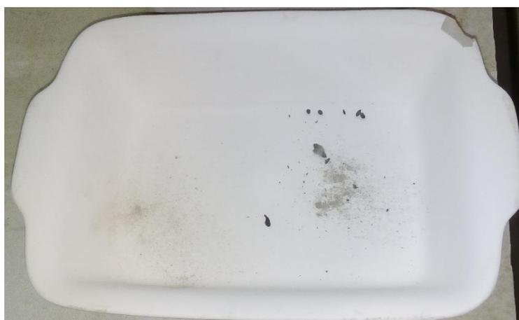
**Figura 1.5.** Contaminação de uma peça vidrada com massa lubrificante, material ferroso, pós e areias.
