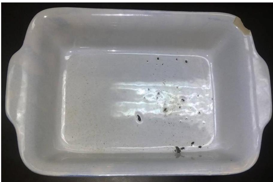
**Figura 1.6.** Defeitos resultantes da contaminação com massa lubrificante, material ferroso, pós e areias.
