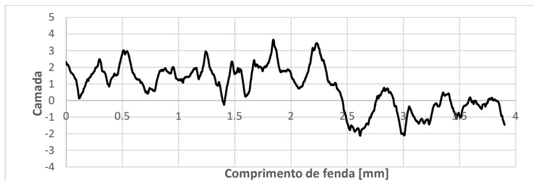
Figura 34 - Perfil de rugosidade da superfície de fratura do provete de 400 mm/s em R=0, com camada por comprimento de fenda.
