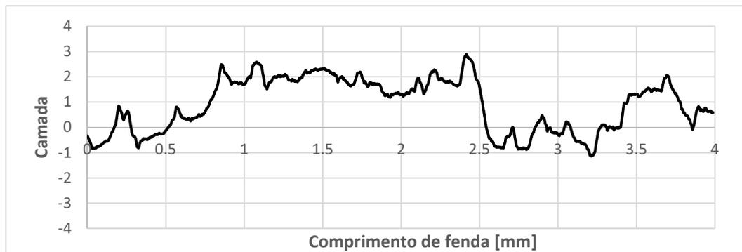
Figura 33 - Perfil de rugosidade da superfície de fratura do provete de 200 mm/s em R=0,6, com camada por comprimento de fenda.
