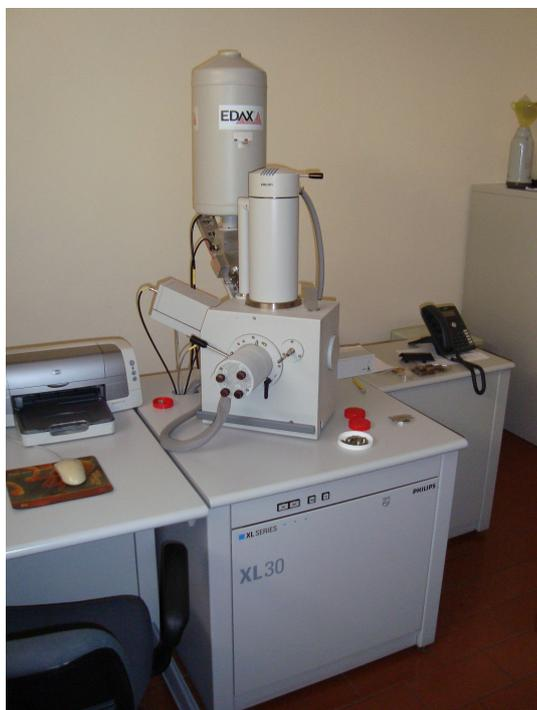
Figura 15 - Microscópio eletrônico por varrimento *Philips XL 30*.
