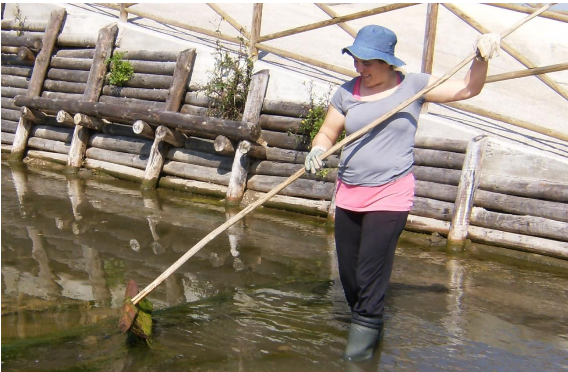
Fotografia 5- Remoção dos limos na salina com o ancinho.
