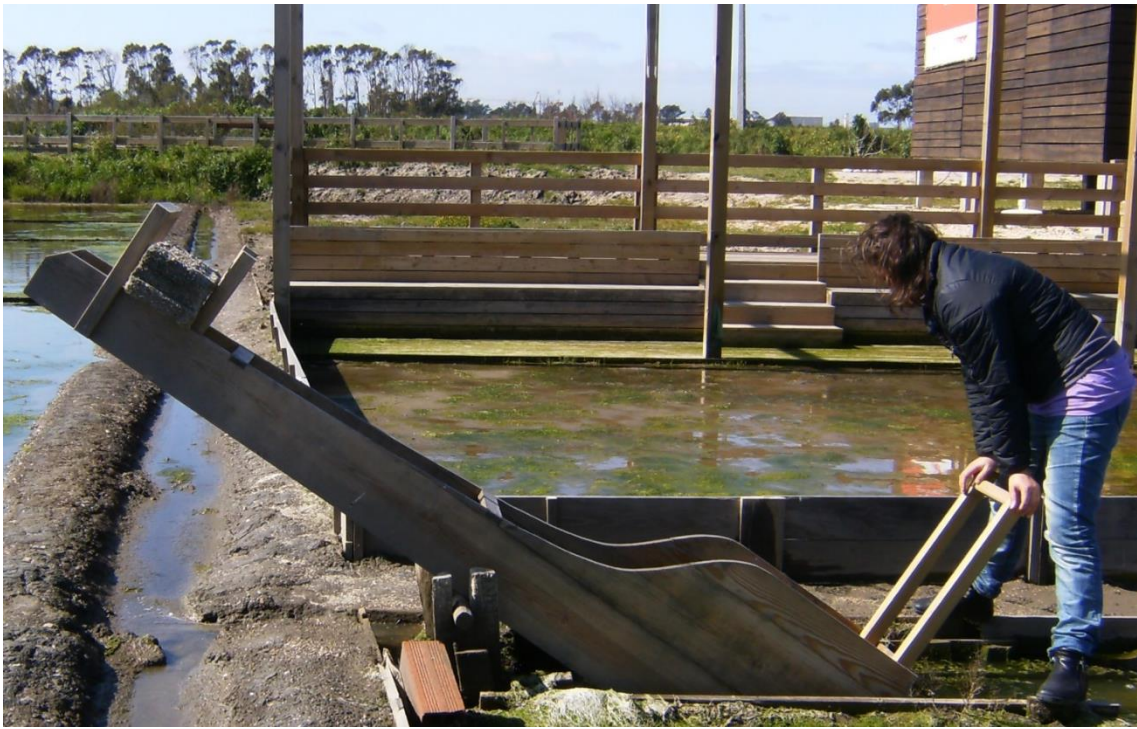
Fotografia 6- Uso da bomba manual de elevação de água.
