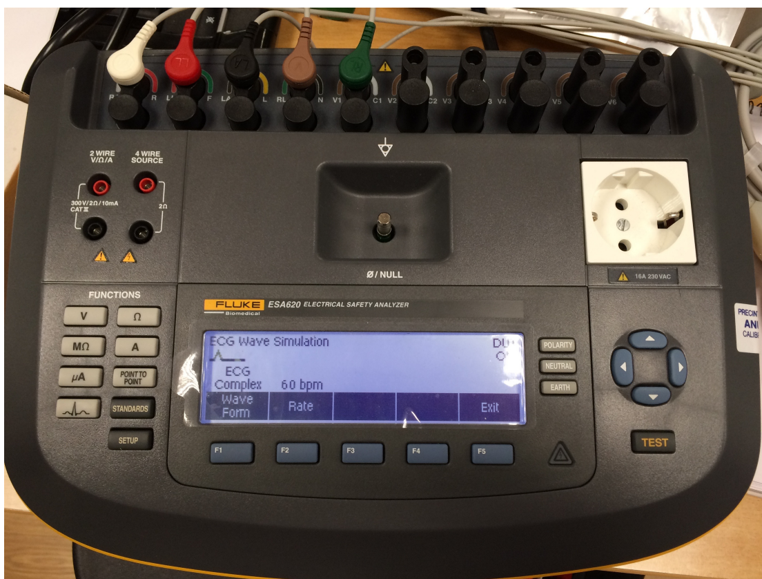
FIGURA 8.2: Representação Fluke ESA 620 a gerar um sinal ECG de 60bpm.
