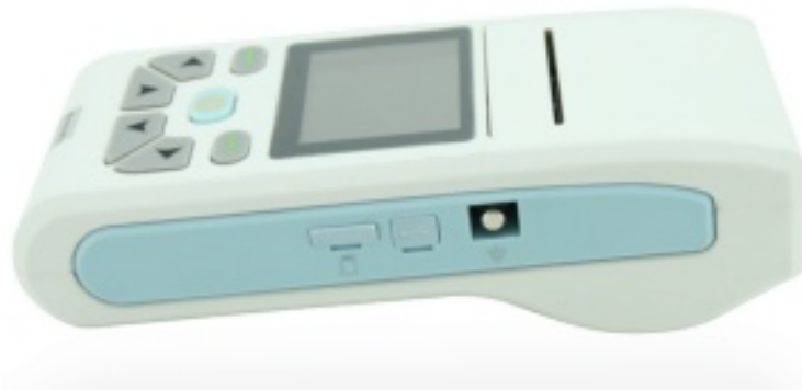
FIGURA 2.13: Dispositivo ECG de 1 canal com ecrã TFT tátil que permite a visualização em tempo real de sinais adquiridos com 12 elétrodos[20].
