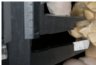
Figura 10 – Medição da altura de referência e da largura vestibulo palatina a 1, 3 e 5mm da margem gengival
