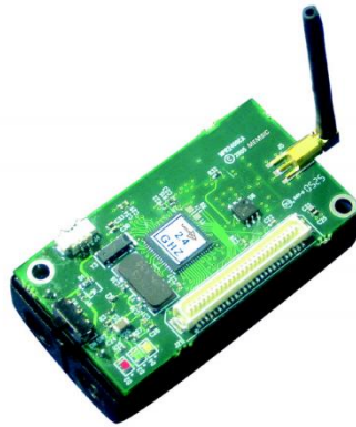
Figura 4 - Nó Sensor MicaZ [16].
