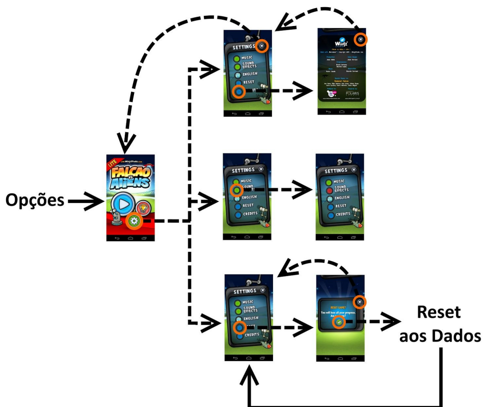
Figura 21 - Organização Detalhada do Videojogo “Falcao vs Aliens” - Fluxo do Menu de Opções - Parte 4/5 Legenda: Seta contínua- apenas há um caminho possível e a transição é automática ou através do touch no ecrã; Setas contínua- necessário pressionar botão específico; Seta curva- retroceder.
