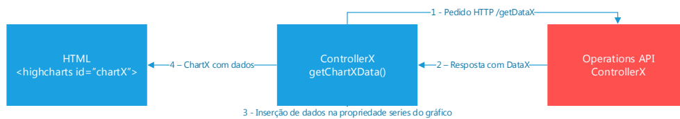
Figura 36 - Exemplo de pedido efetuado para obtenção de dados que alimentam um gráfico
