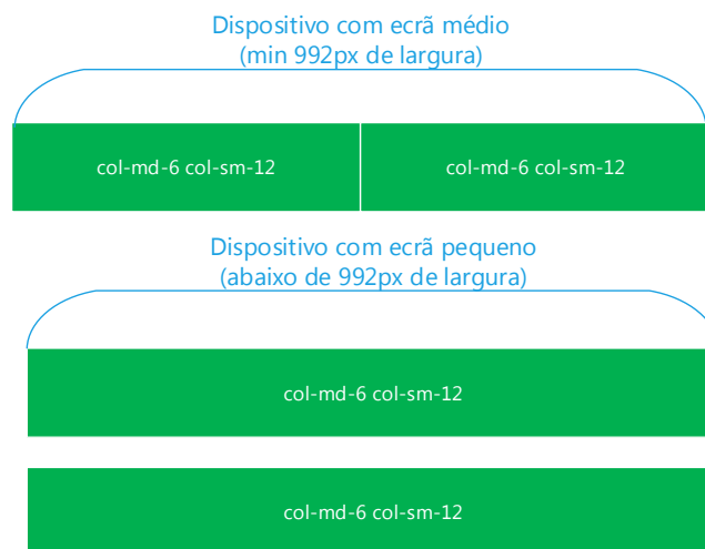
Figura 32 - Exemplo de uso do Bootstrap para se obter um design responsivo
