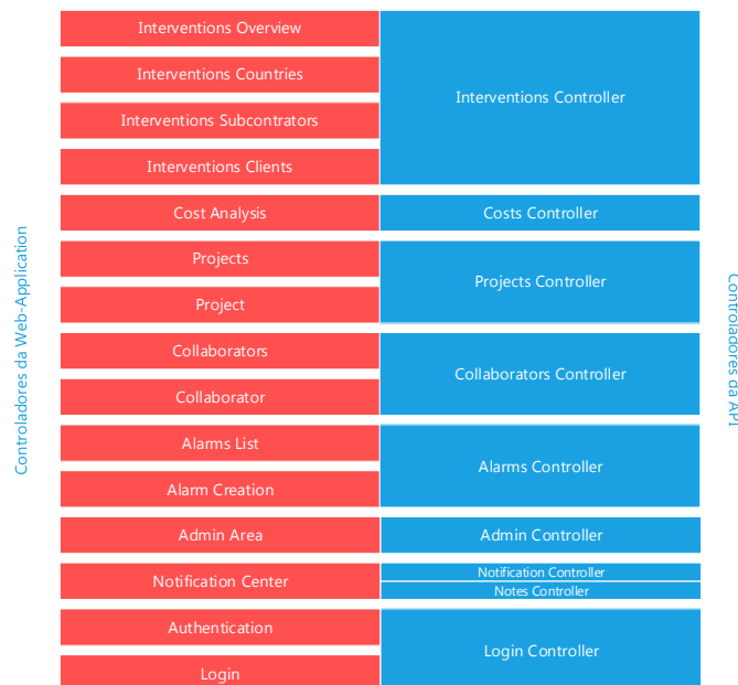
Figura 28 – Relação entre controladores da web application e controladores da API
