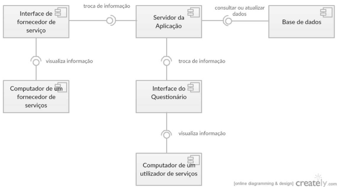
Figura 7: Diagrama de componentes da ferramenta Web
