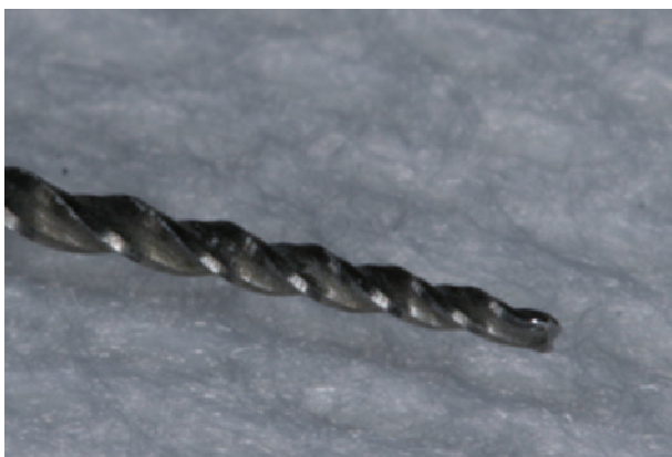
Fig.1 Fotografia de um instrumento ProTaper® fracturado por fadiga cíclica.
