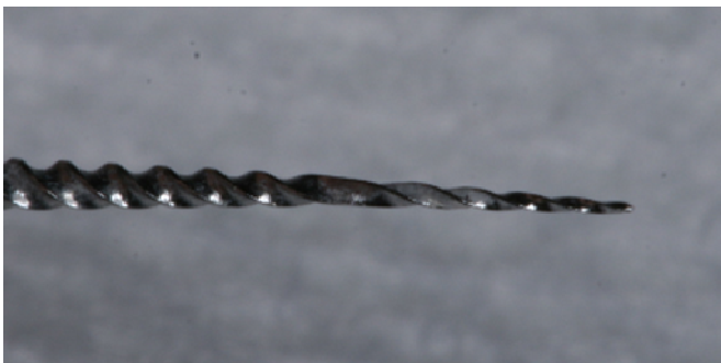
Fig.2 Fotografia de uma alteração morfológica de uma lima Profile 20/06.
