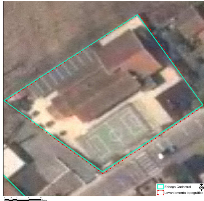
Figura 30 – Comparação da informação obtida com levantamento cadastral e com interpretação dos ortofotos em zona urbana.
