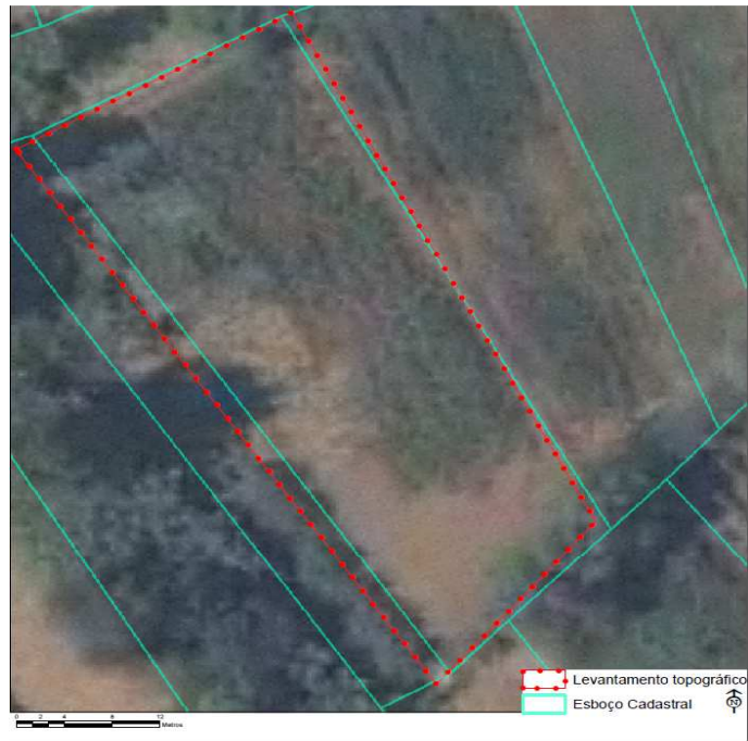
Figura 29 – Comparação da informação obtida com levantamento cadastral e com interpretação dos ortofotos em zona rústica.
