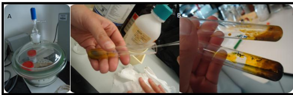
Figura 15 – Etapas de conservação dos extratos. A: extratos liofilizados são armazenados num exsiccador, no interior de frascos devidamente identificados e selados; B: extratos de hexano foram concentrados com o auxílio de azoto líquido
