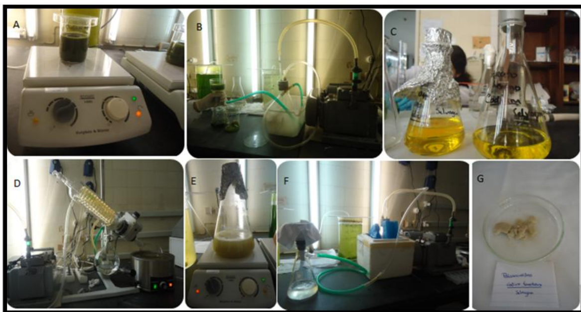
Figura 14 – Etapas do método de extração. A: extração em solvente orgânico; B: filtração a vácuo (filtro de sílica em funil de porosidade G3 acoplados a quitasato ); C: armazenamento do extrato num balão Erlenmeyer ; D: evaporador rotativo (concentração de soluções ou separação de solventes por evaporação); E: extração aquosa (100°C, 2h); F: filtração a vácuo (funil de louça/cerâmica, coberto com um pano, acoplado a um quitasato ); G: Secagem dos polissacarídeos à temperatura ambiente
