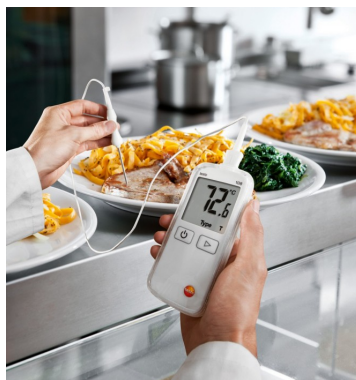
Figura 2.21: Exemplo da utilização de um termómetro por contacto da Testo
