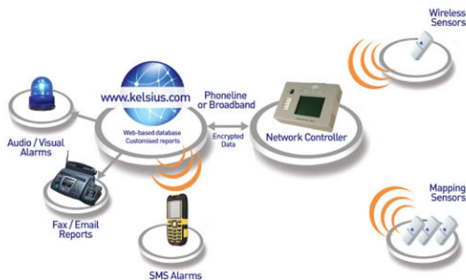
Figura 2.18: Diagrama de funcionamento do ColdCheck
