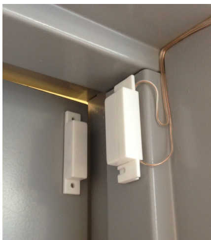
Figura 2.7: Aplicação de um sensor de efeito de Hall para detetar abertura e fecho de porta
