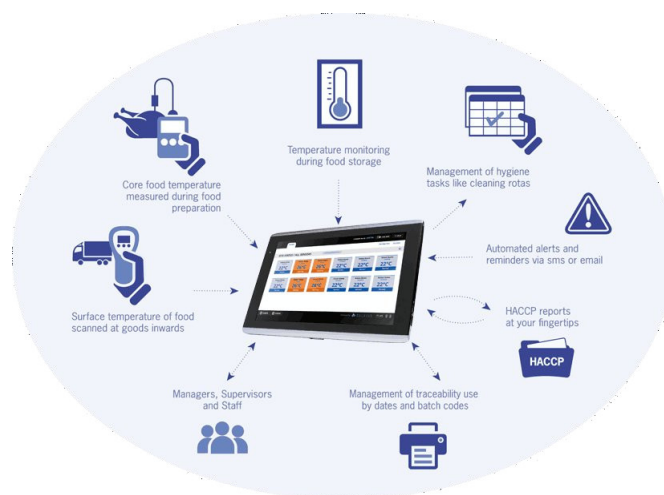
Figura 2.17: Diagrama de funcionamento do FoodCheck
