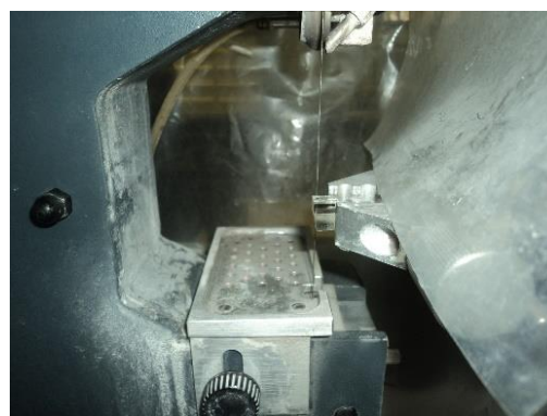
Figura 2.5. Dente queimado a 400°C na garra de suporte durante o processo de corte.
