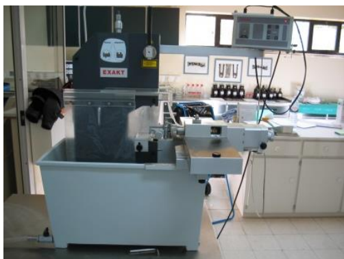
Figura 2.6. Unidade de corte do sistema Exakt onde foram realizados os cortes histológicos.
