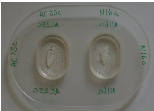
Figura 2.3. Dois dentes queimados a 900°C durante o processo de inclusão na resina.
