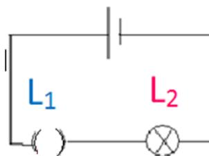
**Figura 14:** Circuito com lâmpadas associadas em série estando uma delas fundida
